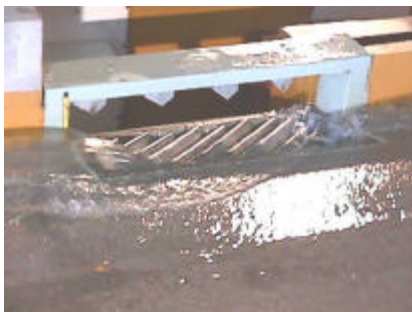
Sumidero con reja de fondo INA-Indupag S.A. – Variante 1 – Q_{CALLE} = 50 \text{ l/s} - i=0.5\%
