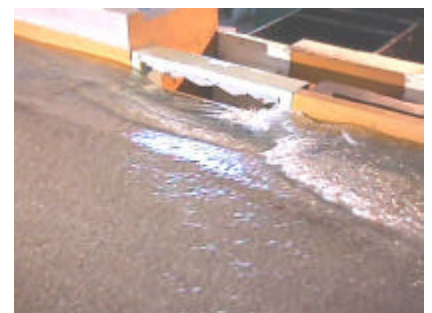
Sumidero con reja de fondo INA-Indupag S.A. – Variante 1 – Q_{CALLE} = 150 \text{ l/s} - i=0.5\%
