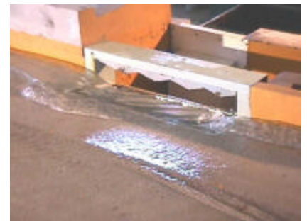
Sumidero con reja de fondo INA-Indupag S.A. – Variante 1 – Q_{CALLE} = 50 \text{ l/s} - i=0.5\%
