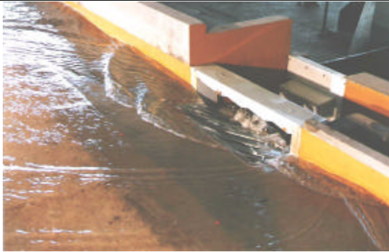
Sumidero con reja de fondo INA-Indupag S.A. – Variante 1 – Q_{CALLE} = 50 \text{ l/s} - i=0.1\%
