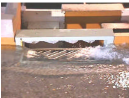
Sumidero con reja de fondo INA-Indupag S.A. – Variante 1 – Q_{CALLE} = 150 \text{ l/s} - i=0.5\%
