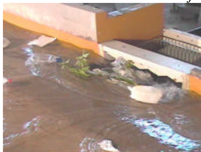
Sumidero con la variante 3 de reja de fondo tipo INA – Indupag – Q_{CALLE} = 50 l/s
