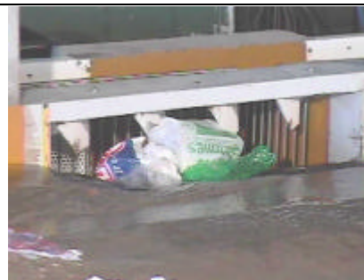
Sumidero con la variante 3 de reja de fondo tipo INA – Indupag – Q_{CALLE} = 30 l/s
