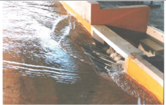
Sumidero con reja de fondo INA-Indupag S.A. – Variante 1 – Q_{CALLE} = 50 \text{ l/s} - i=0.1\%
