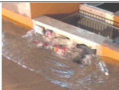
Sumidero con la variante 1 de reja de fondo tipo INA – Indupag – Q_{CALLE} = 50 l/s
