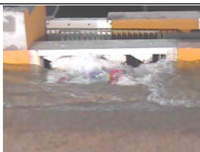
Sumidero con la variante 1 de reja de fondo tipo INA – Indupag – Q_{CALLE} = 100 l/s
