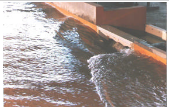
Sumidero con reja de fondo INA-Indupag S.A. – Variante 1 – Q_{CALLE} = 150 \text{ l/s} - i=0.1\%
