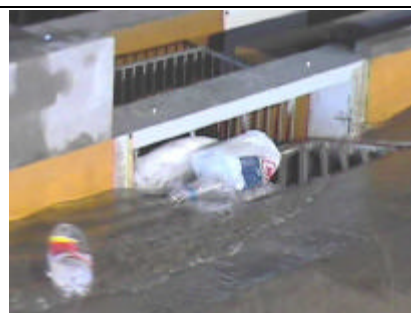
Sumidero con la variante 1 de reja de fondo tipo INA – Indupag – Q_{CALLE} = 30 l/s
