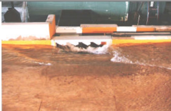
Sumidero con reja de fondo INA-Indupag S.A. – Variante 1 – Q_{CALLE} = 150 \text{ l/s} - i=0.1\%
