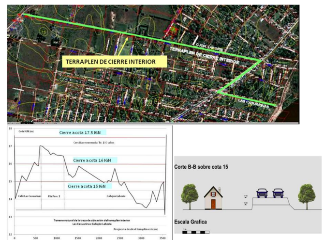
Figura N° 7: Traza del terraplén interior
