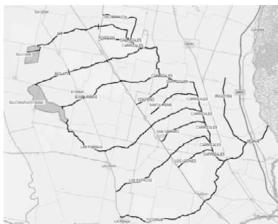
Figura 4.- Esquema Topológico de la cuenca, con zonas de almacenamientos (ESC2-RAS).
