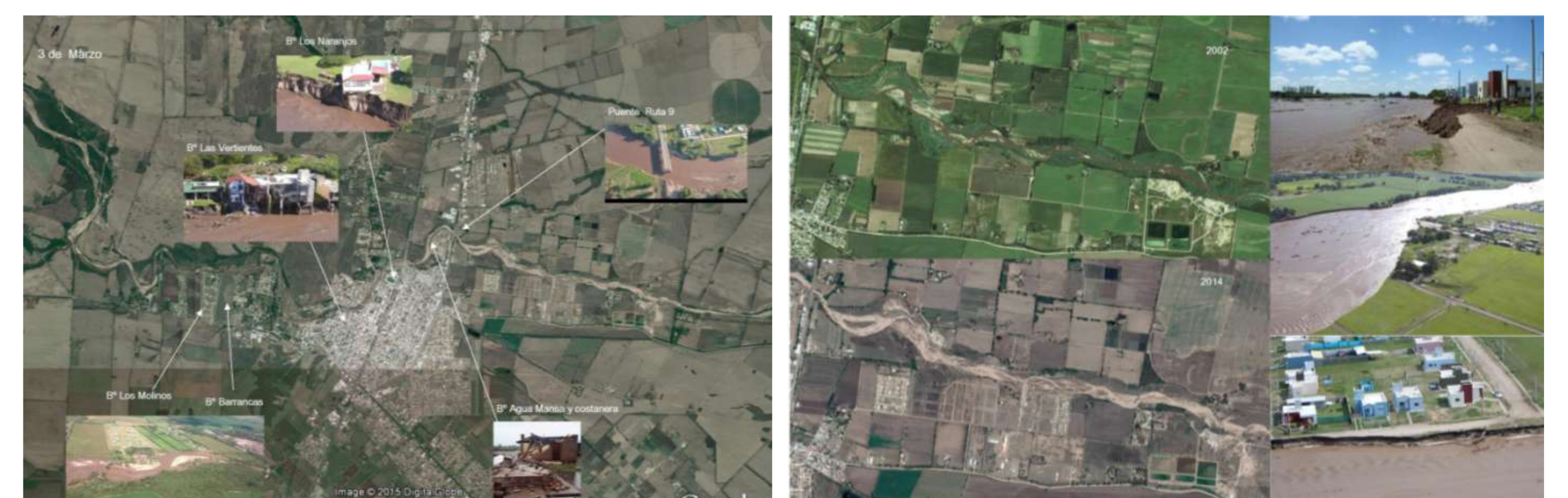
Figura N°2: Arriba Imagen spot 5,(11/3/15) resolución 10m, que muestra el desarrollo areal afectado por la crecida de 2015. Fuente CONAE. Abajo: Esquema Síntesis de daños. Fuente: Elaboración propia en base a Imagen Google earth 2014.
