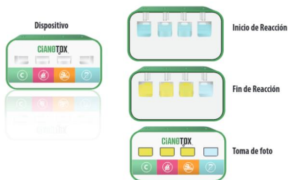
Figura 3.- Prototipo provisorio de CIANOTOX-Field. En cada pocillo se colocarán los reactivos y PP1 adecuados para el control y los 3 rangos de medición..
