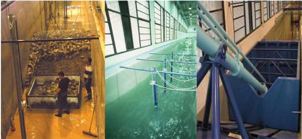
Figura 8.3 Modelo a gran escala e instalaciones del canal de olas del LIM de la UPC, España (Vidal et al., 2003).
