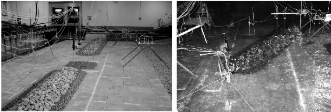
Figura 8.8: Modelo del rompeolas de baja cresta en el laboratorio de la Universidad de Aalborg, Dinamarca (Kramer et al., 2003).
