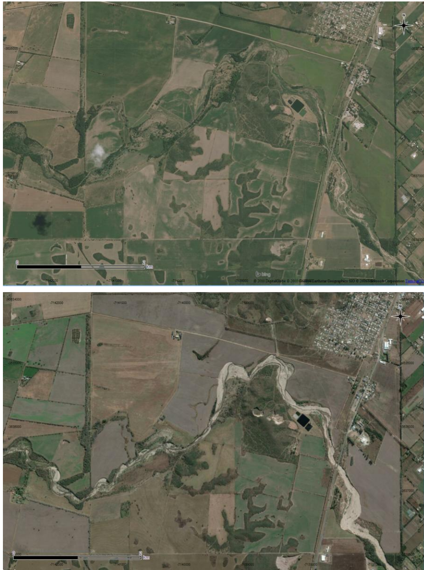
Figura13: Arriba imagen Bing (2010) Abajo Imagen Google (2016). Ampliación de Cauce Río Carnero luego de la creciente del año 2015. RN9
