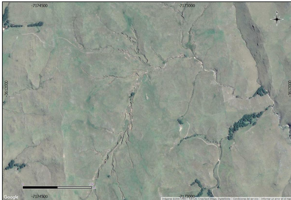
Figura 3: Erosión retrogradante en loess, cabeceras Arroyo La Barrosa
