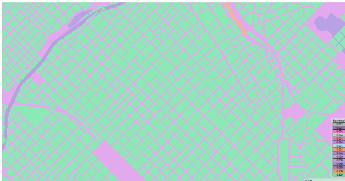
Figura 4.8. Mapa de zonificación a escala Ciudad del coeficiente de rugosidad n de Manning
