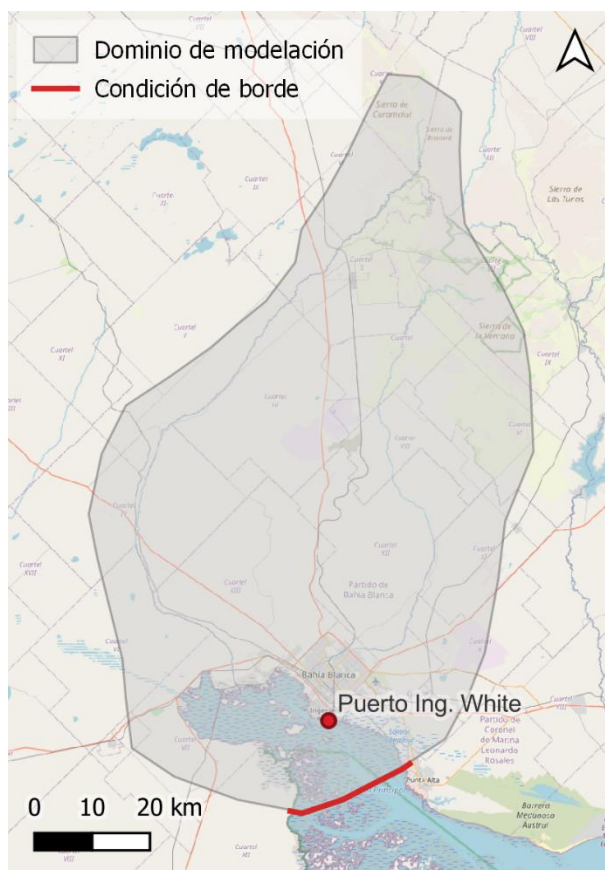
Figura 4.1. Dominio de modelación y condición de borde.
