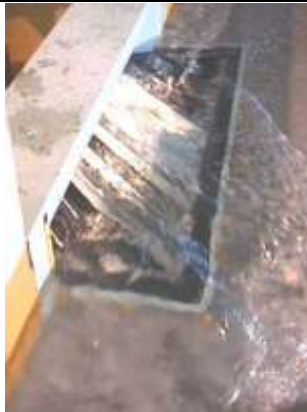
Sumidero con reja de fondo INA-Indupag S.A. – Variante 2 – Q_{\text{CALLE}} = 50 \text{ l/s} - i=0.5\%
