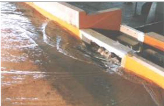
Sumidero con reja de fondo INA-Indupag S.A. – Variante I – Q_{CALLE} = 50 \text{ l/s} - i=0.1\%
