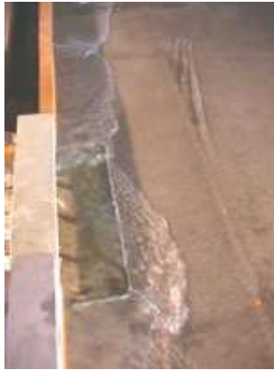
Sumidero con reja de fondo obstruida – Q_{\text{CALLE}} = 50 \text{ l/s} - i=0.5\%
