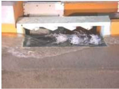
Sumidero con reja de fondo INA-Indupag S.A. – Variante 3 – Q_{CALLE} = 50 \text{ l/s} – i=0.5\%
