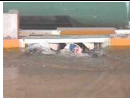
Sumidero con reja de fondo tipo O.S.N. – Q_{CALLE} = 50 \text{ l/s}
