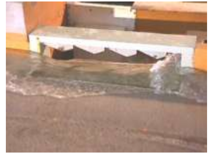
Sumidero con reja de fondo obstruida – Q_{\text{CALLE}} = 50 \text{ l/s} - i=0.5\%
