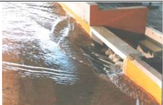
Sumidero con reja de fondo INA-Indupag S.A. – Variante I – Q_{CALLE} = 50 \text{ l/s} - i=0.1\%
