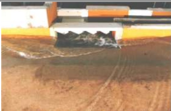
Sumidero con reja de fondo tipo O.S.N. – Q_{CALLE} = 50 \text{ l/s} - i=0.1\%
