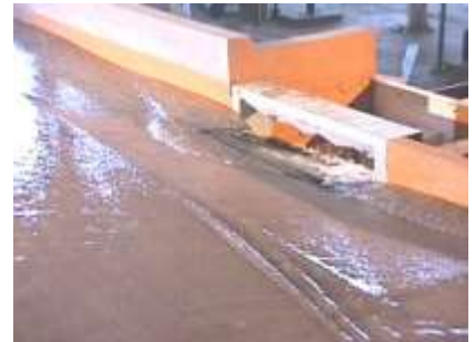
Sumidero con reja de fondo INA-Indupag S.A. – Variante 2 – Q_{\text{CALLE}} = 50 \text{ l/s} - i=0.5\%
