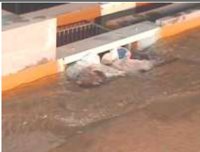
Sumidero con reja de fondo tipo O.S.N. – Q_{CALLE} = 50 \text{ l/s}
