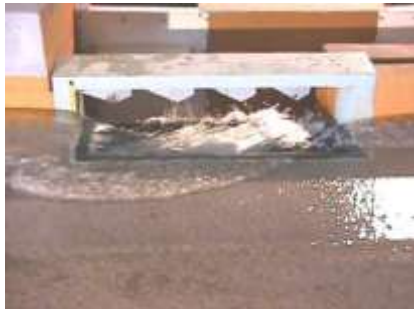
Sumidero con reja de fondo INA-Indupag S.A. – Variante 2 – Q_{\text{CALLE}} = 50 \text{ l/s} - i=0.5\%
