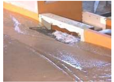
Sumidero con reja de fondo INA-Indupag S.A. – Variante 3 – Q_{CALLE} = 50 \text{ l/s} – i=0.5\%
