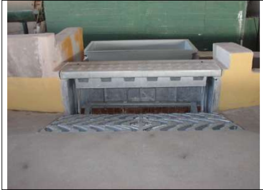
Fotografía N° 1. Vista en detalle del modelo de reja ensayado
