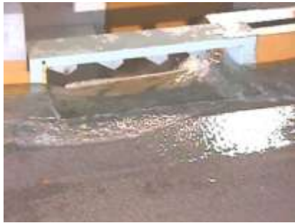
Sumidero con reja de fondo obstruida – Q_{\text{CALLE}} = 50 \text{ l/s} - i=0.5\%
