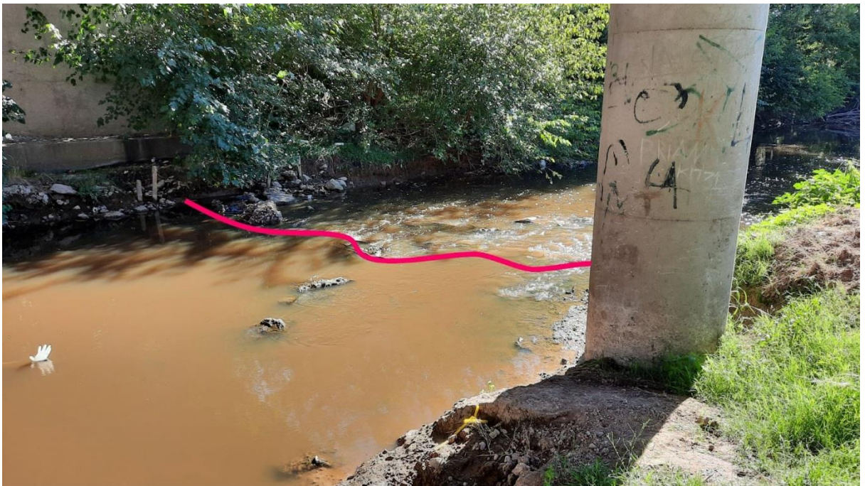
Figura 3.3. Sección de control (señalada en rojo) en la Estación de Monitoreo 01 de ACUMAR (foto tomada el 26/02/2021).
