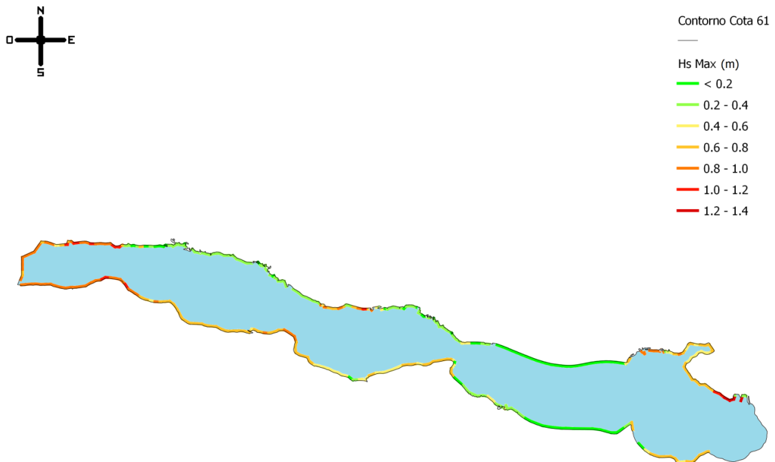
Figura 4.9. Altura de ola H_s (m) sobre el contorno del embalse para Tr = 10 años
