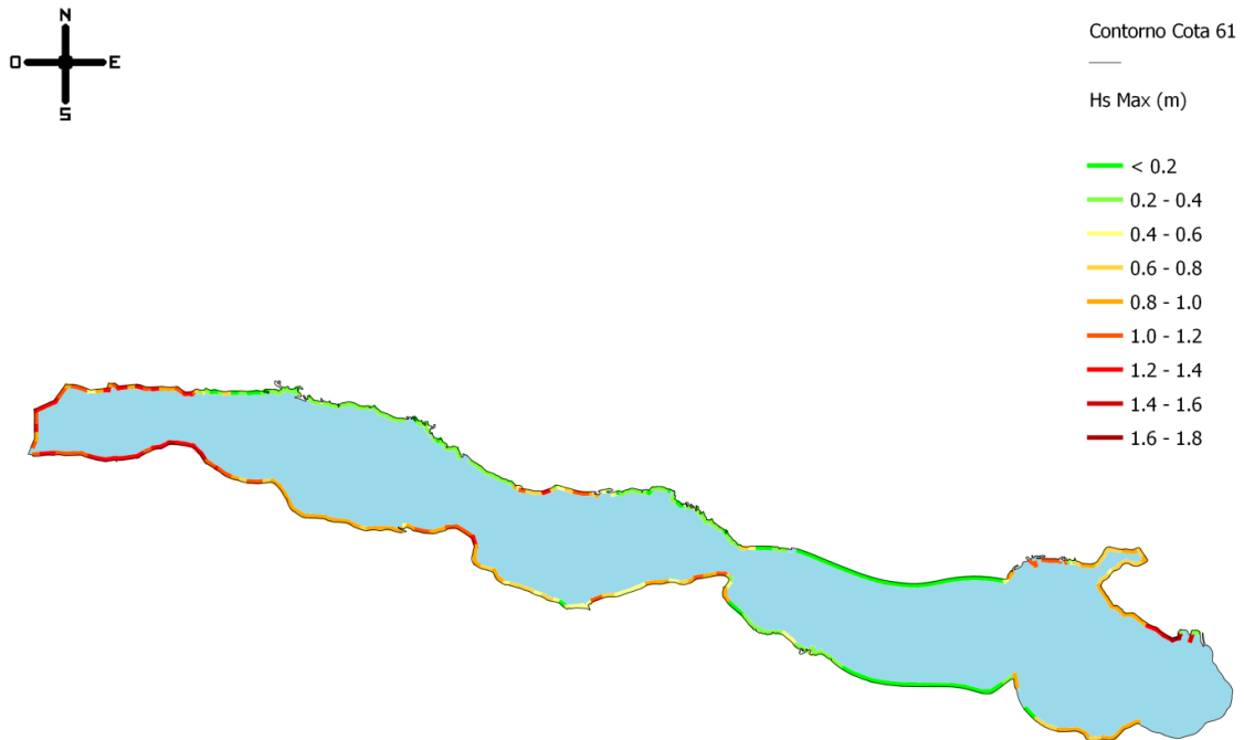
Figura 4.10. Altura de ola H_s (m) sobre el contorno del embalse para T_r = 100 años
