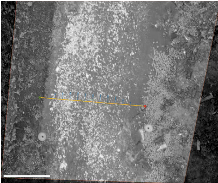
Figura A.73. Campo de velocidades superficiales en la EM77 obtenido con el software RIVER.
