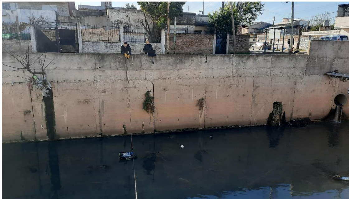
Figura A.44. Aforo con ADCP en la EM16
