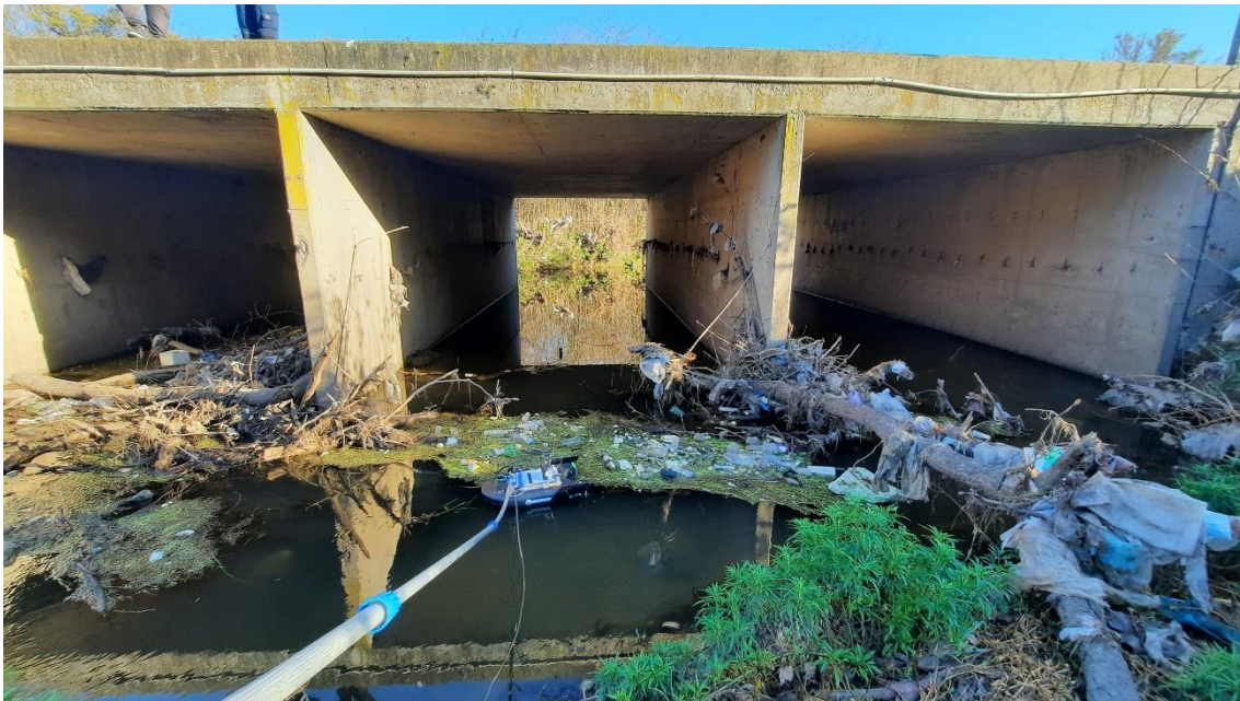
Figura A.19. Aforo con ADCP en la EM10.
