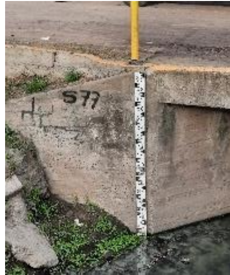
Figura A.71. Nivel del curso registrado por la regla hidrométrica de la EM77
