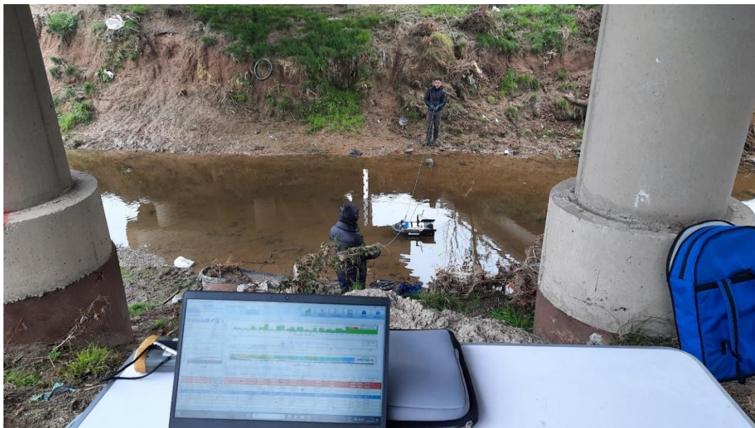
Figura A.3. Aforo con ADCP en la EM03.
