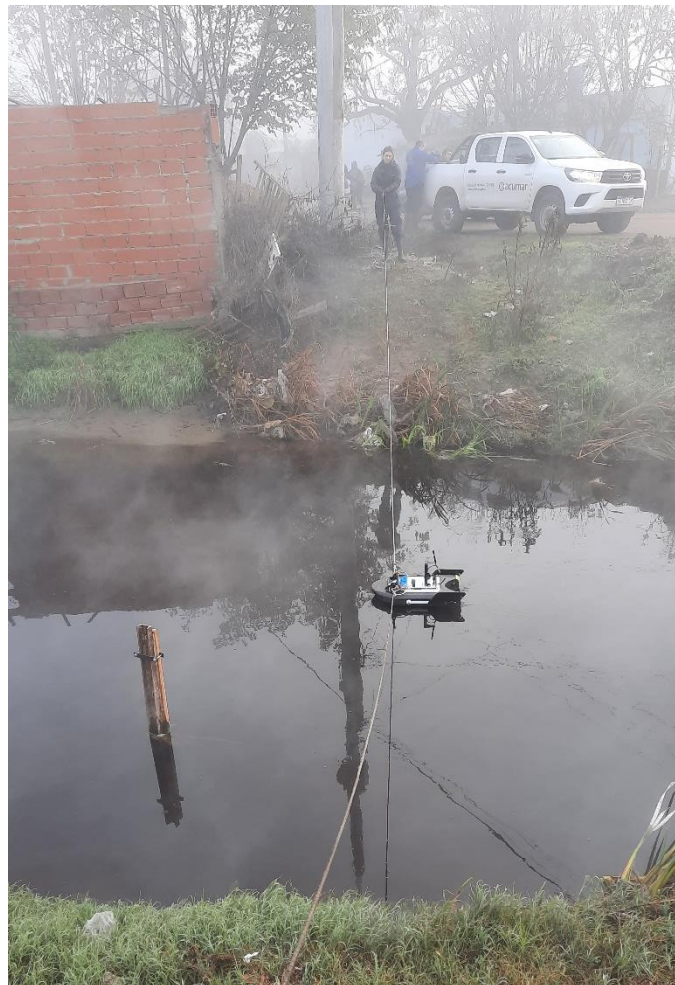
Figura A.8. Aforo con ADCP en la EM04.
