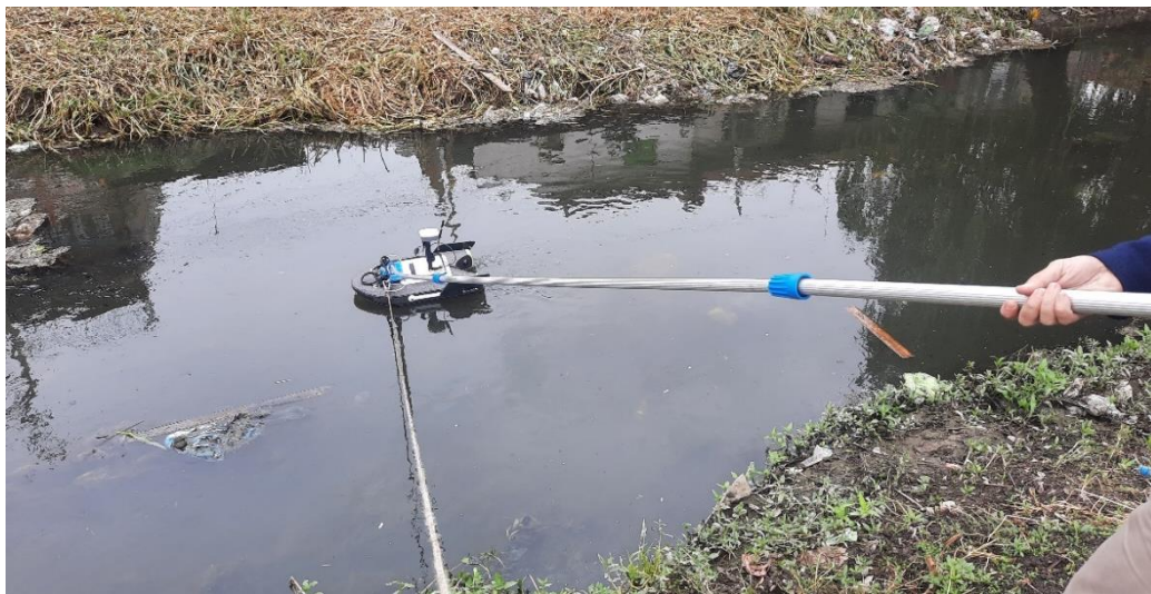
Figura A.39. Aforo con ADCP en la EM14.
