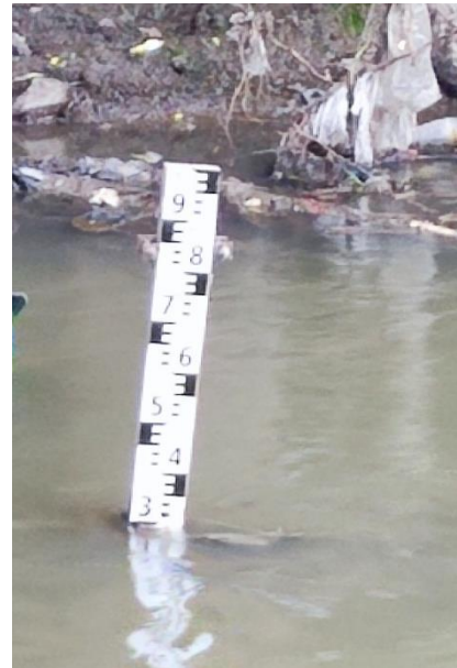
Figura A.13. Nivel del curso registrado por la regla hidrométrica de la EM08
