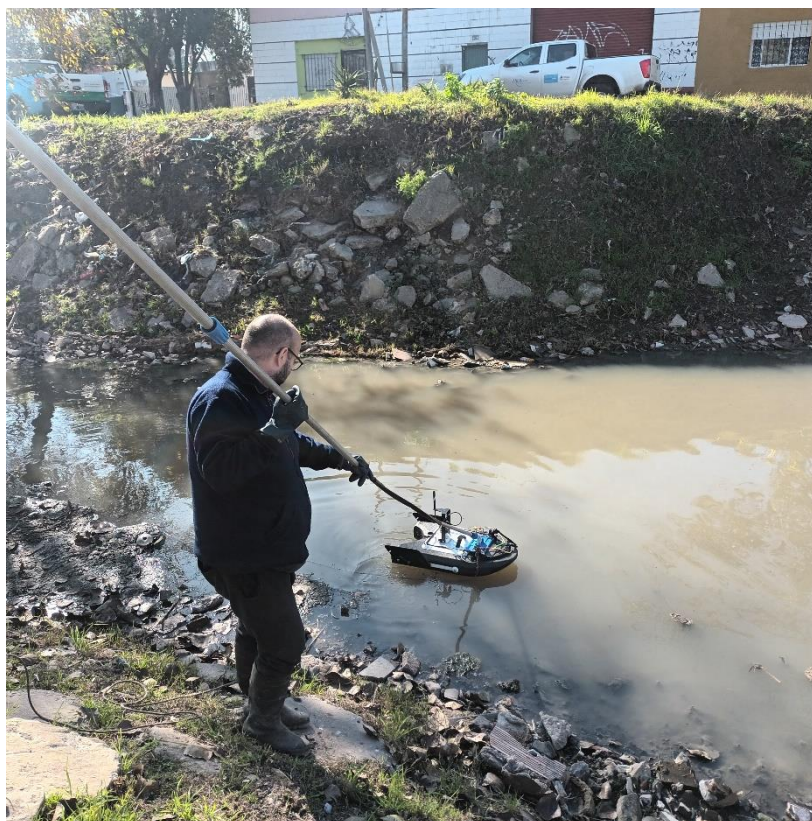
Figura A.77. Realización del aforo en Sitio D, sobre el Aº Del Rey.
