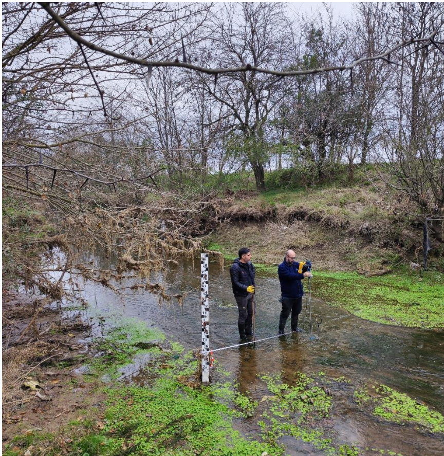
Figura A.63. Aforo con ADV en la EM68.
