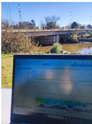
Figura A.30. Aforo con ADCP en la EM12.
