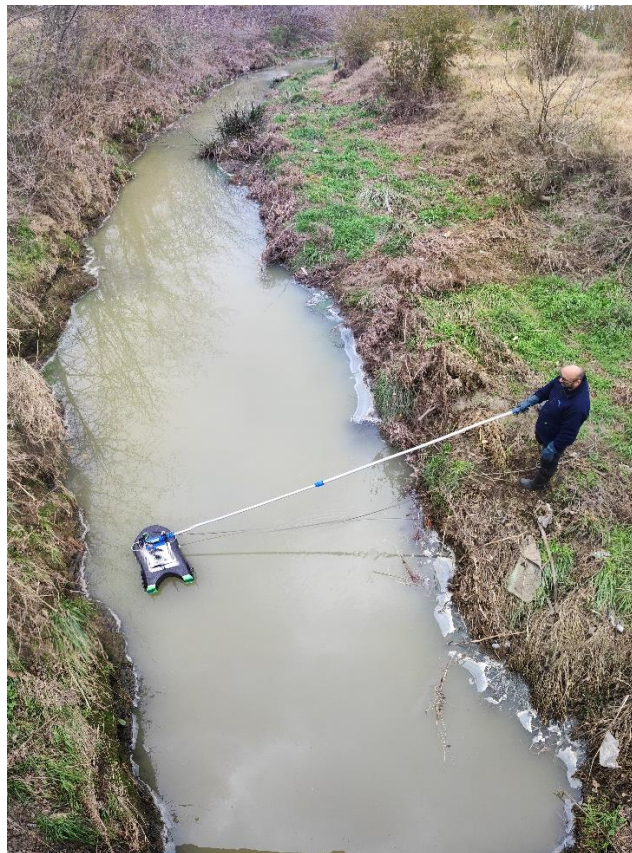
Figura A.54. Aforo con ADCP en la EM41.
