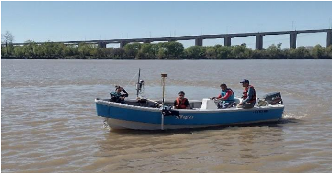
Figura 4.1. Montaje de ADCP y Ecosonda a ambos lados de la embarcación.
