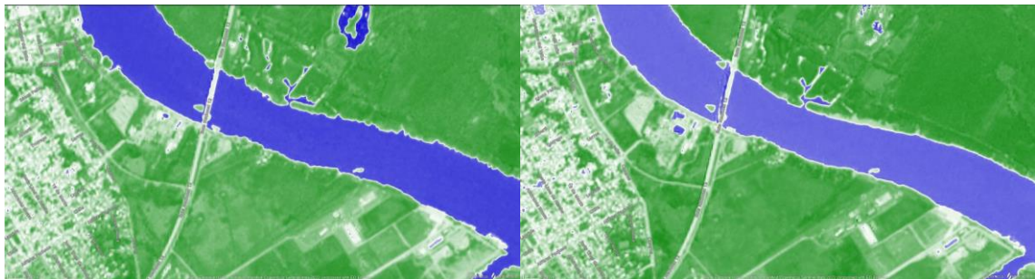
Figura 1.2. Máscara de agua en la zona de erosión, años 2018 (izquierda) y 2020 (derecha).
