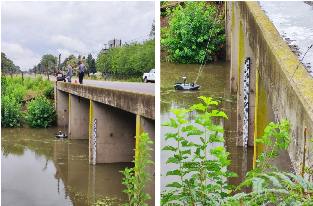
Figura A.4. Aforo con ADCP en la EM10.
