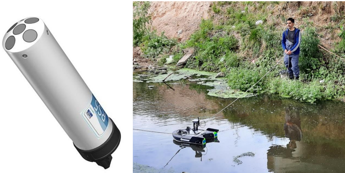
Figura 2.4. Configuración de los sensores del ADCP RS5 (izquierda) y utilización del equipo en los aforos del presente proyecto (derecha)
