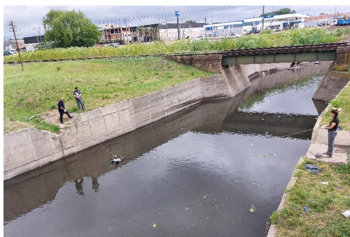
Figura A.22. Calibración del equipo ADCP (izquierda) y aforo en la EM11 (derecha).
