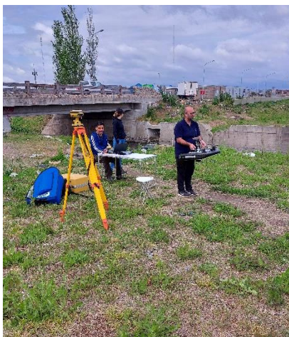
Figura A.22. Calibración del equipo ADCP (izquierda) y aforo en la EM11 (derecha).
