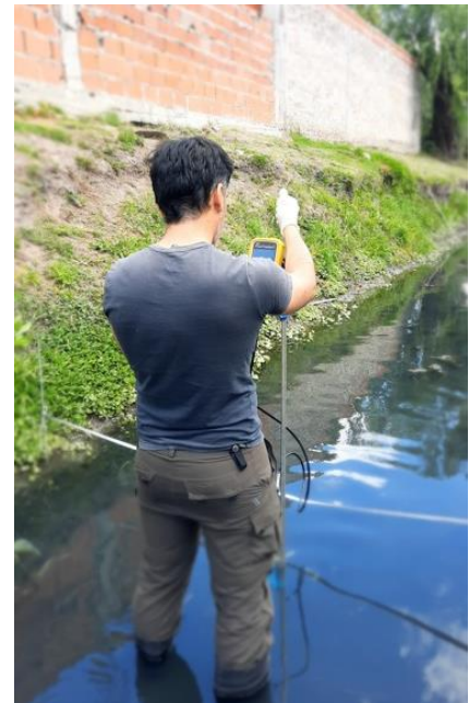
Figura 2.2. ADV FlowTracker2 Sontek con sus diversos componentes (izquierda) y utilización del equipo en los aforos del presente proyecto (derecha).
