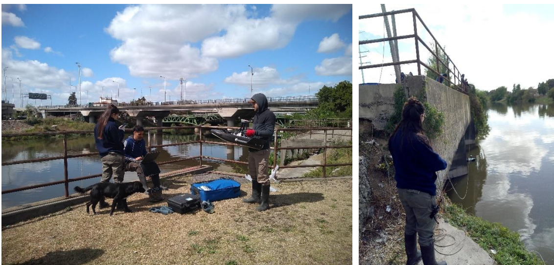
Figura A.99. Aforo con ADCP en la EM78.
