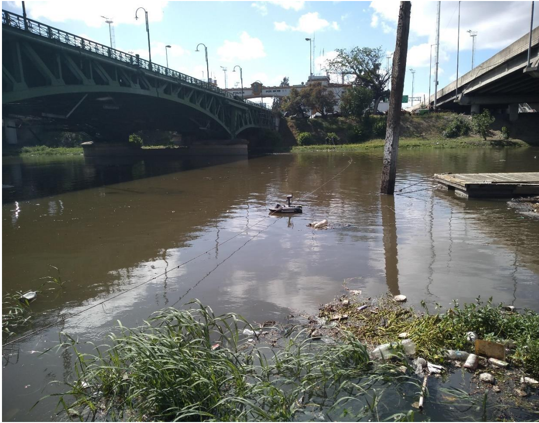
Figura A.47. Aforo con el ADCP mediante sogas desde ambas márgenes en la EM17.
