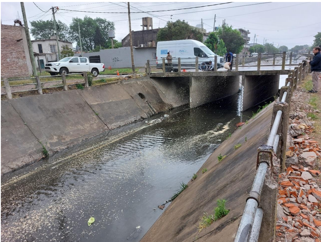
Figura A.94. Sembrado de trazadores para el aforo con LSPIV en la EM76.
