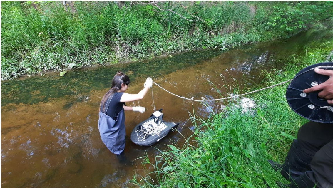
Figura A.85. Bajada del equipo ADCP para luego realizar el aforo en la EM72.
