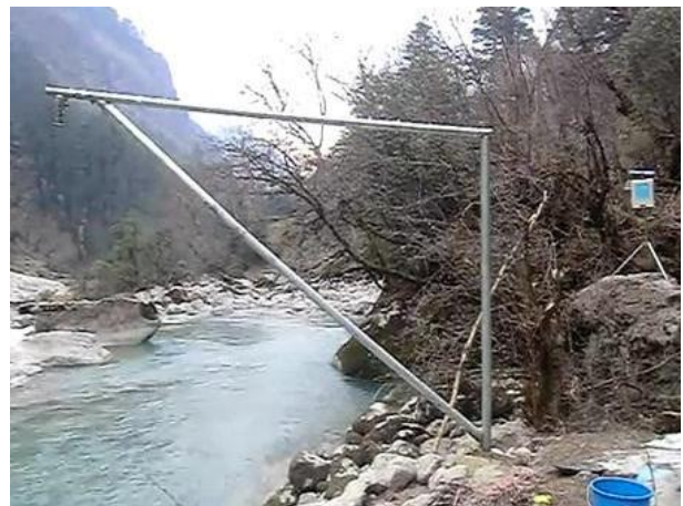
Figura 19. Imágenes instalación sensor de radar
