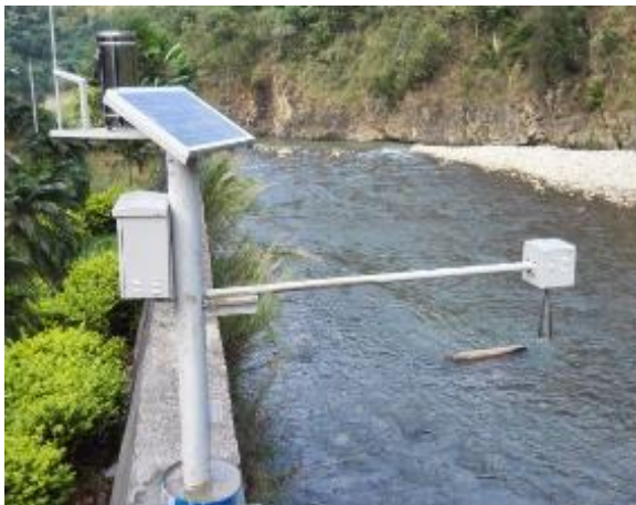
Figura 19. Imágenes instalación sensor de radar
