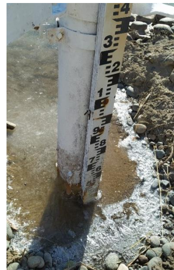
Figura 18. Imágenes instalación sensor de presión sobre una margen congelada en época invernal
