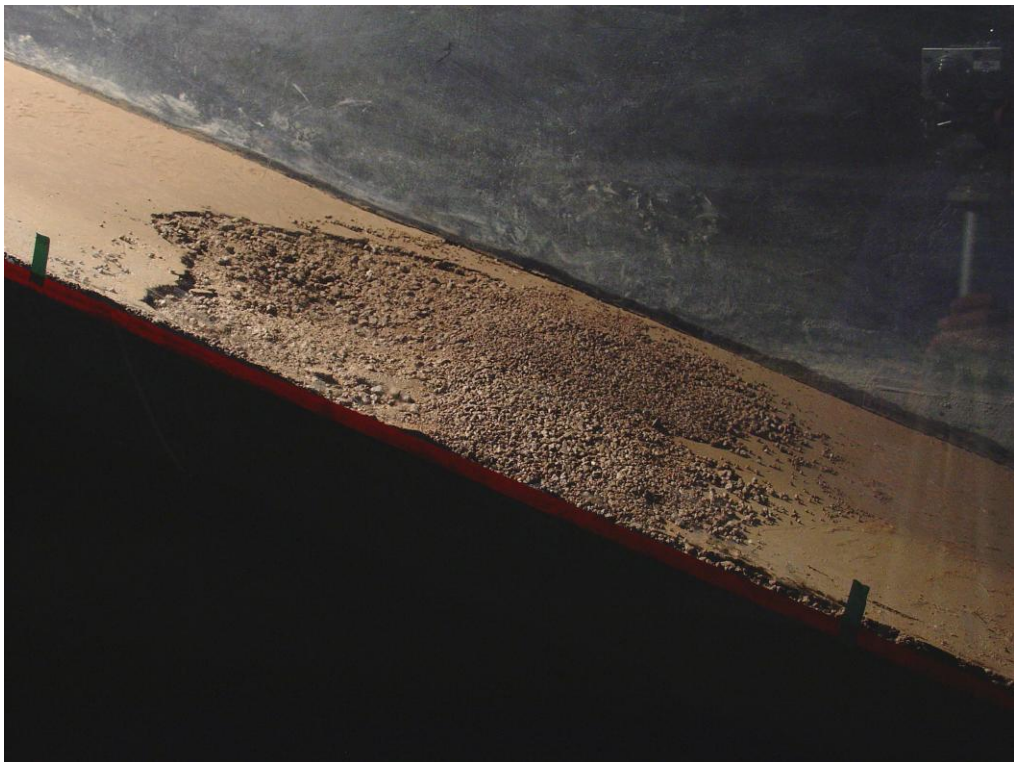
Foto 9: Estado final del talud en uno de los casos que ocurrió la deformación excesiva del talud.
