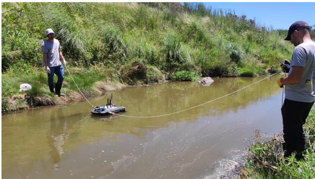
Figura 2.5. Aforo con ADCP RS5 en el Arroyo Cañuelas el 11/12/2023
