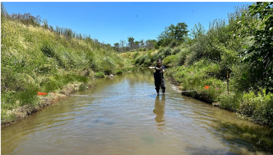
Figura 2.4. Aforo con FlowTracker II en el Arroyo Cañuelas el 11/12/2023
