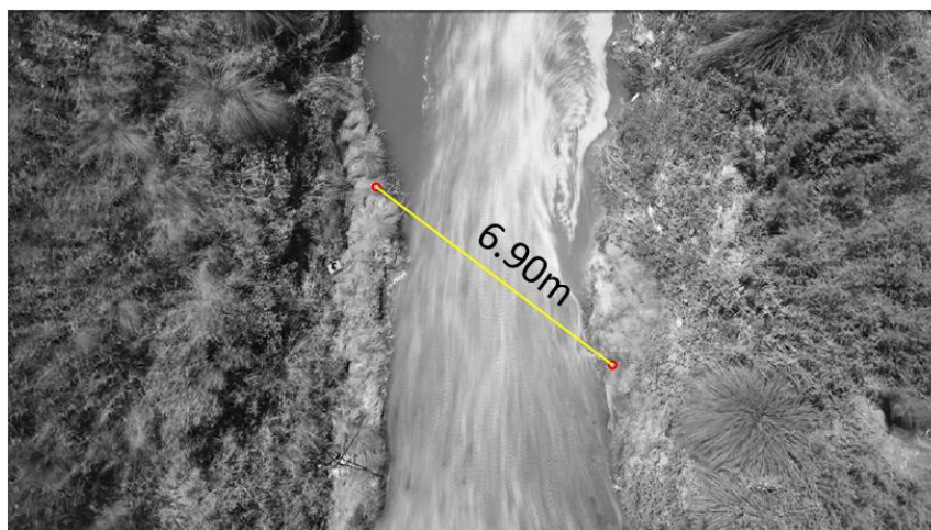
Figura 3.22. Ubicación de Puntos de Control y distancia real entre ellos para la definición de la escala de pixel, video con visión cenital.
