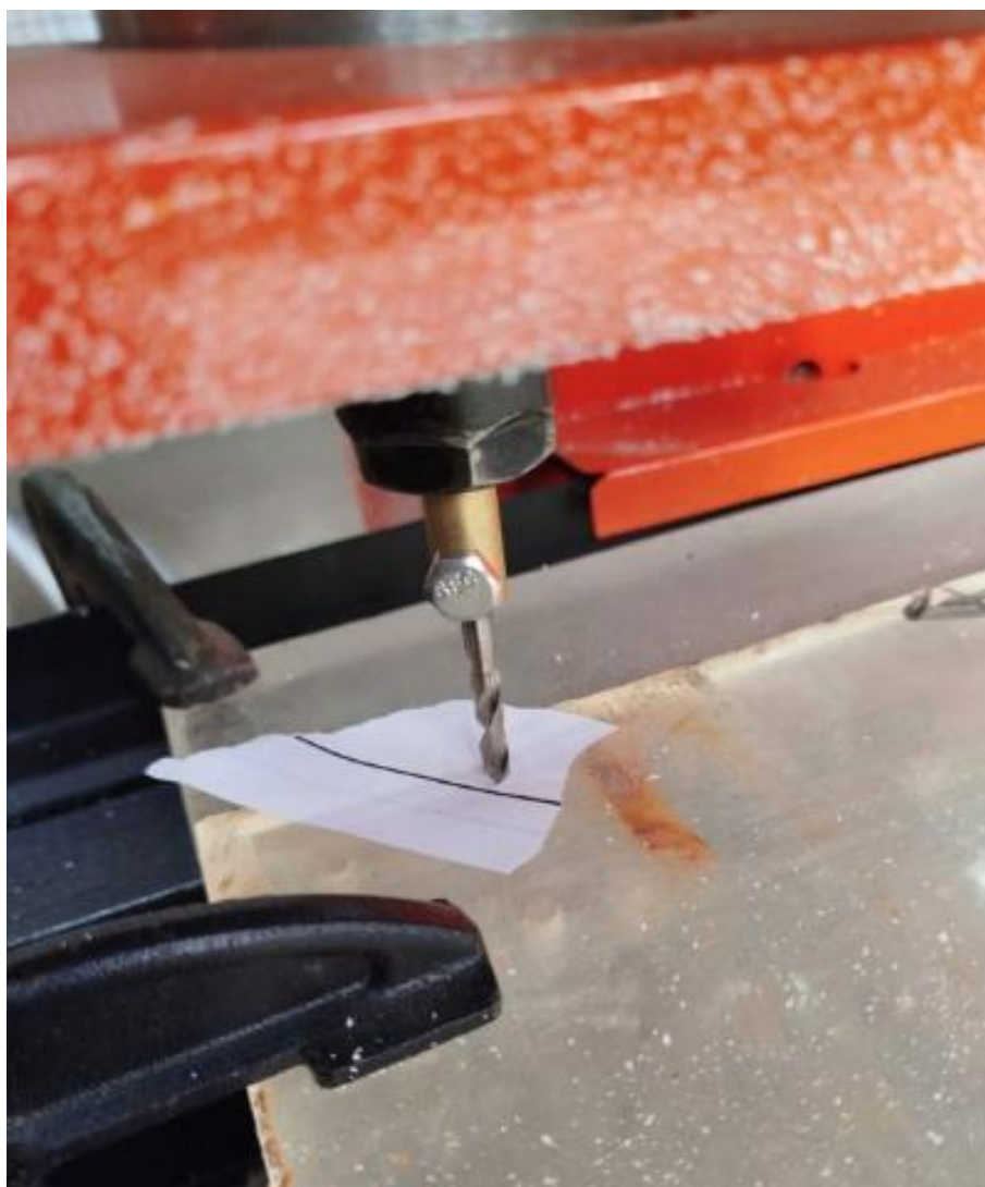
Figura 3.8. Palpado de herramientas para determinar compensación en Z.
