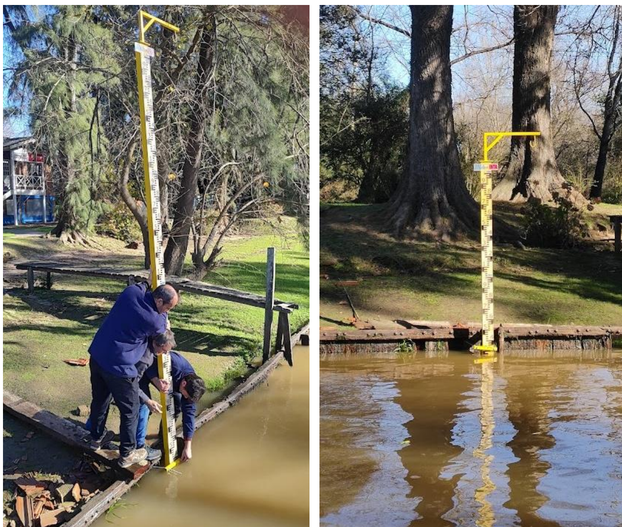
Figura 5.1. Instalación de las reglas hidrométricas
