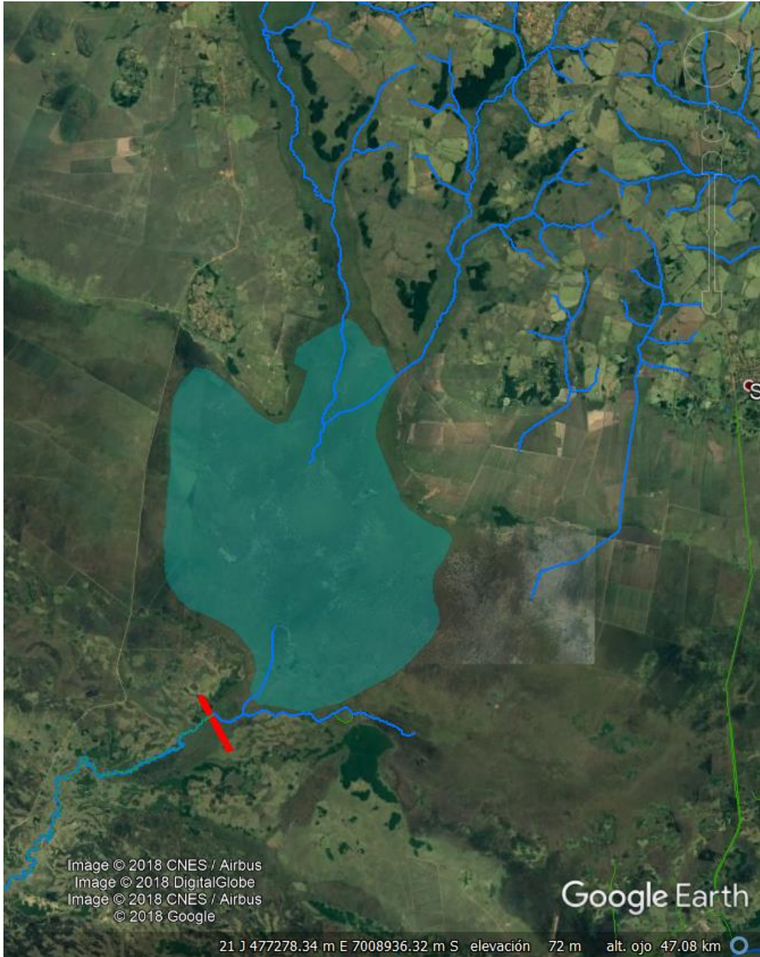
Figura 4.4. Cauces y zona de bañados del Arroyo Yabebyry. El polígono azul-verdoso muestra la extensión aproximada del bañado, y la línea roja indica la sección transversal utilizada para estimar la relación altura-descarga.
