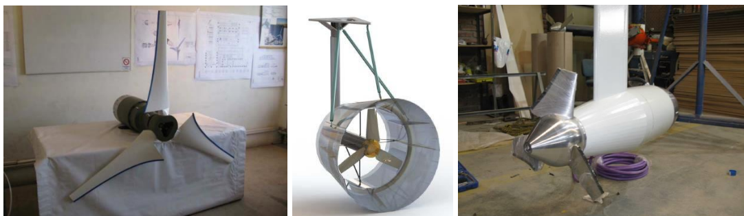
Figura 2.27. Prototipos de turbinas de 4.5 KW a escala real de INVAP INGENIERÍA S.A.
