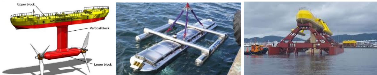
Figura 2.25. Turbina ATIR: Esquema (izquierda), Prototipo a escala 1:10 (centro) y Prototipo a escala real (derecha).
