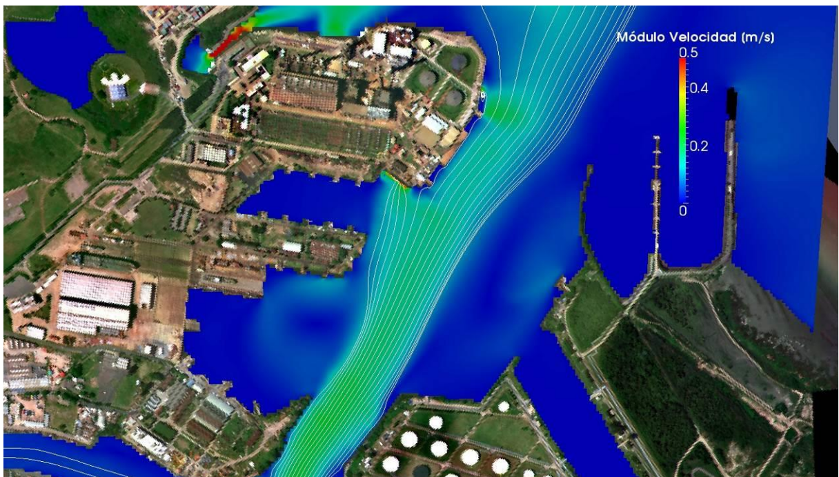
c) Escenario C. Tubos de corriente de 10 \text{ m}^3/\text{s} .
