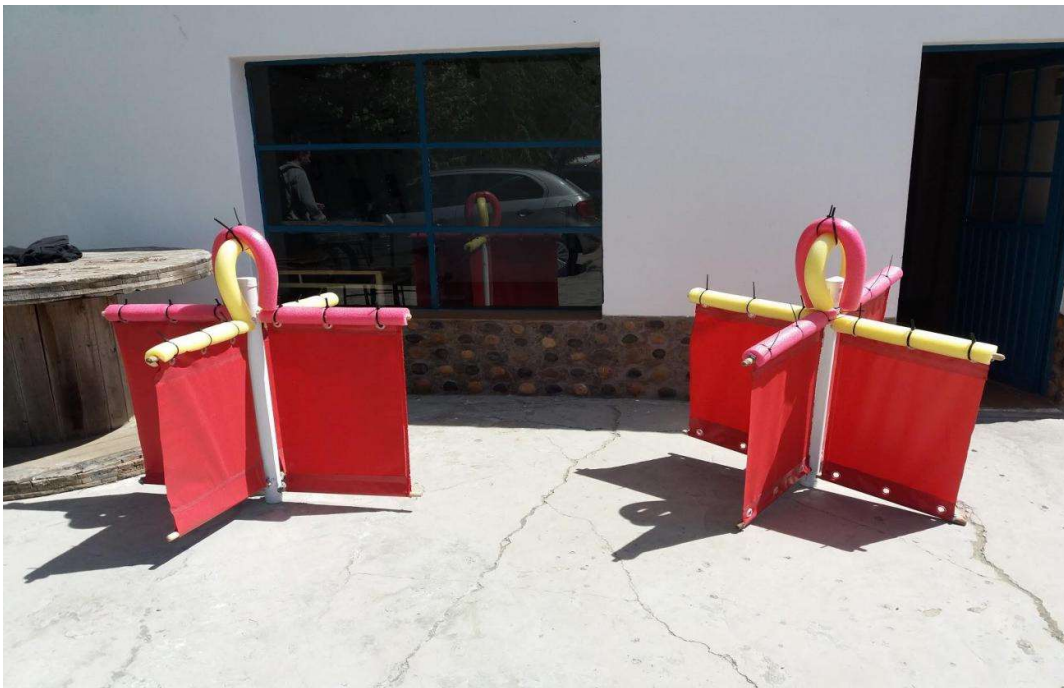
Figura A.3. Armado de flotadores.
