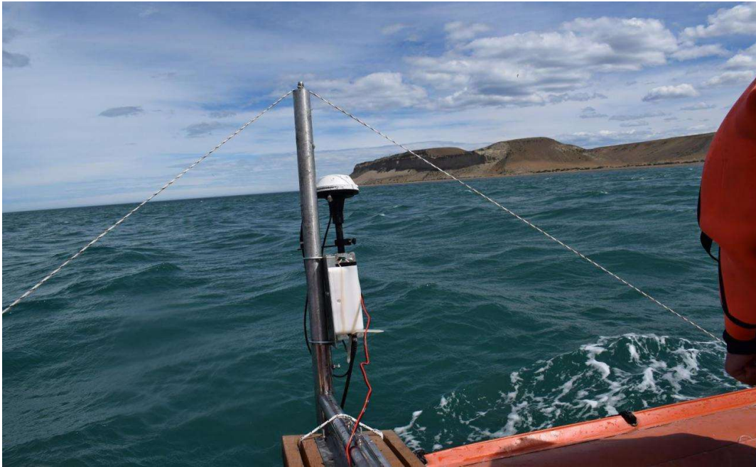
Figura A.2. Instalación de ADCP en embarcación.
