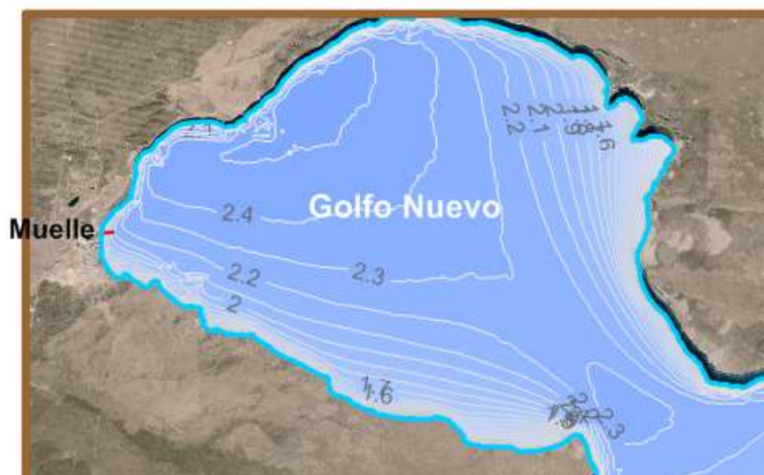
Figura 8 – Curvas de isoamplitud de altura de ola ( H_s ) en m, en la región de cálculo.
