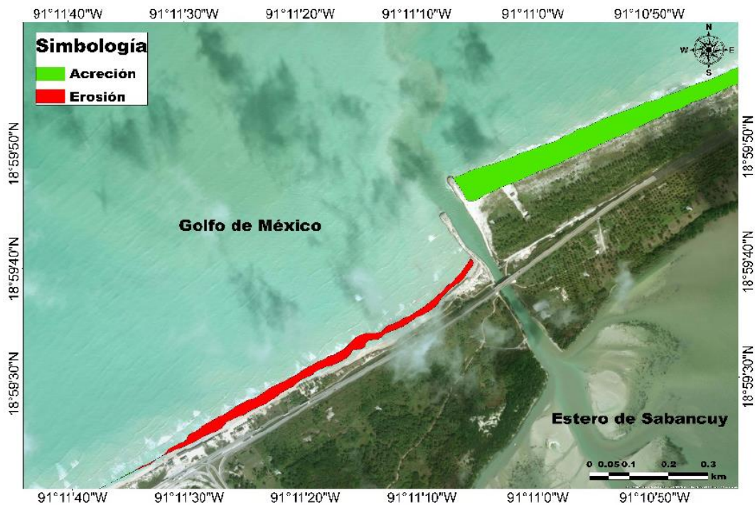
Figura 4.6. Detalle de las áreas de acreción y erosión en la zona del canal de acceso (Kuc Castilla, 2018).
