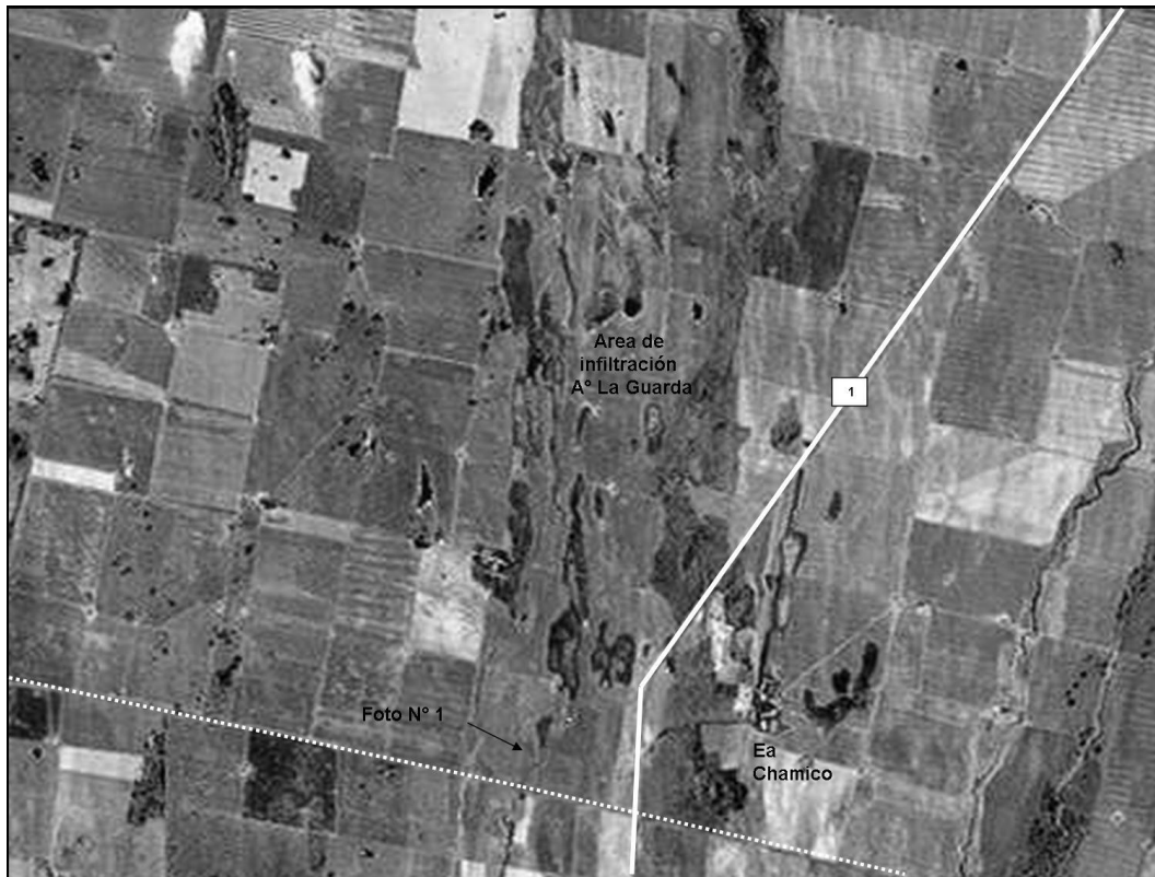
Fig. 47. Zona de explayamientos e infiltración del A° La Guardia Izquierda: fotomosaico 1962. Sistema de drenaje influente con ausencia de lagunas. Derecha: Imagen TM 2008.
