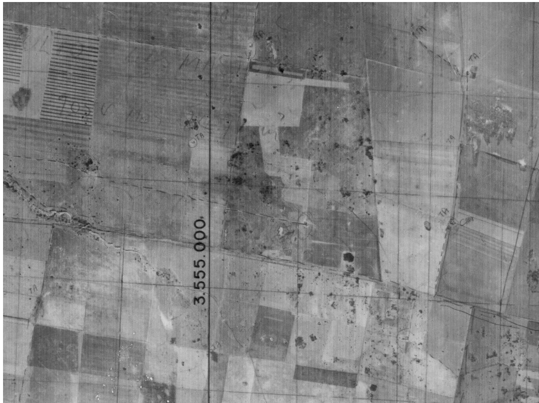
Fig. 57. Fotomosaico año 1962. Falta de una red de drenaje organizada y ausencia de afloramiento del nivel freático.
