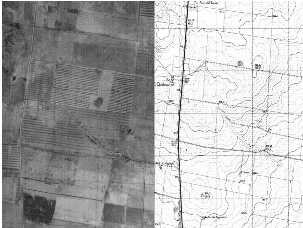
Fig. 72. Fotomosaico año 1962 (izquierda) y Carta IGM El Quebrachal Hoja 3366/29/1. Año 1969 (derecha). Ausencia de red de drenaje organizada y quebrada con clara definición geomorfológica.
