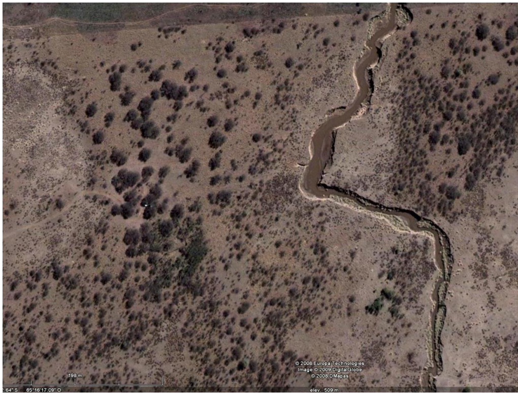
Fig. 45 . A° Z. C° Negro. Tramo entre las rutas nacionales N° 8 y N° 7 cercanías del Pto. Zanón. Encajamiento y ampliación de valle por diseño meandriforme incipiente.
