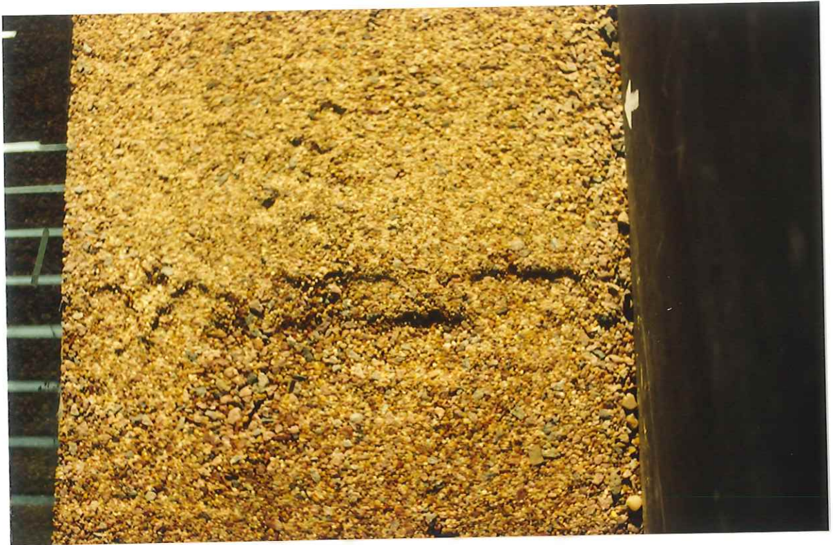
Foto 15: Estado final del filtro finalizado el ensayo 41A.
