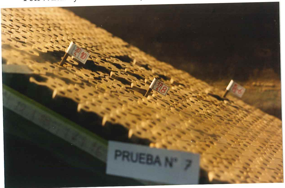
Foto 8: Expulsión de bloque e inestabilidad geotécnica en el ensayo 7.
