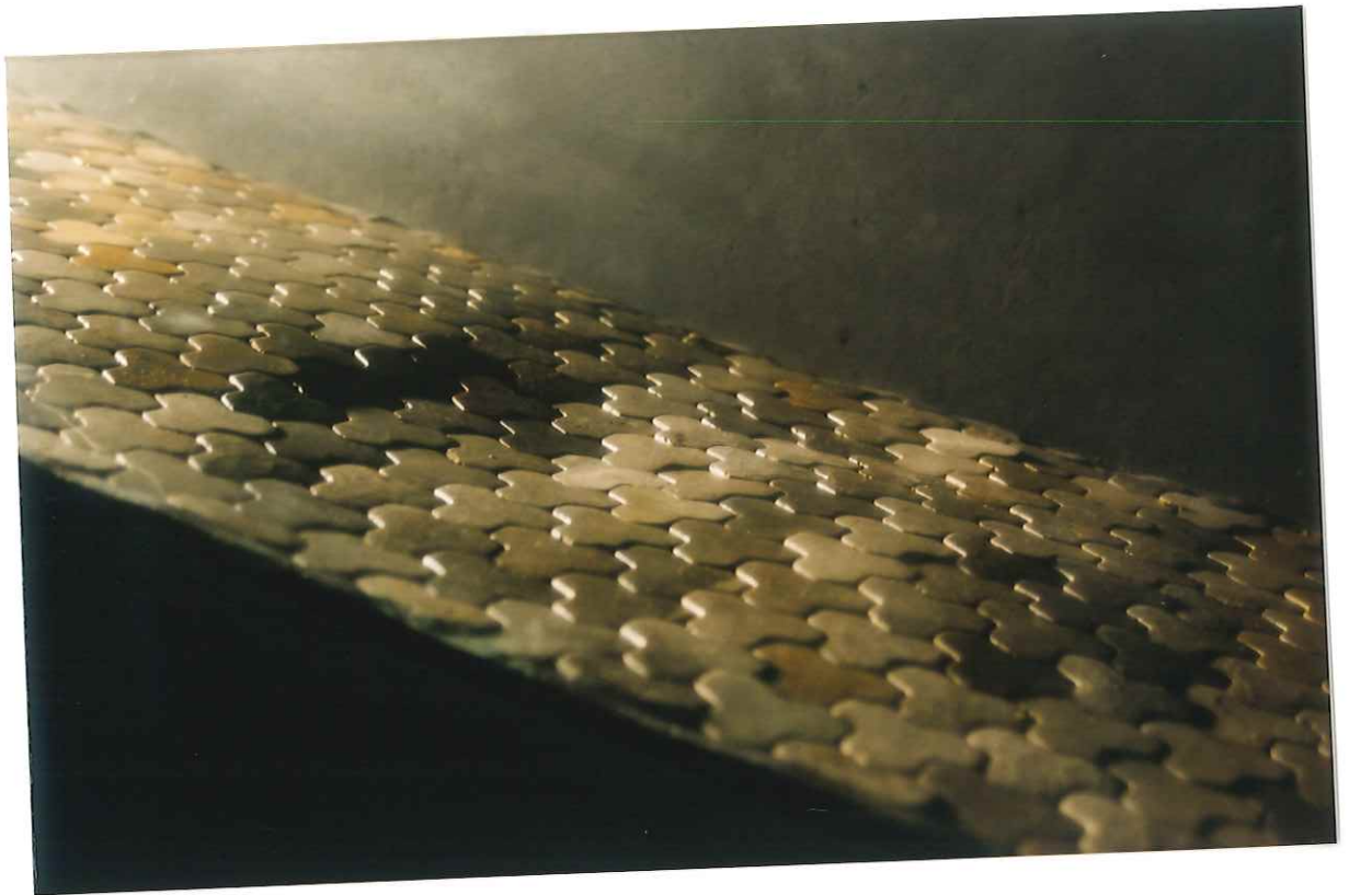
Foto 27: Formación de un perfil tipo "S" en el ensayo 45.
