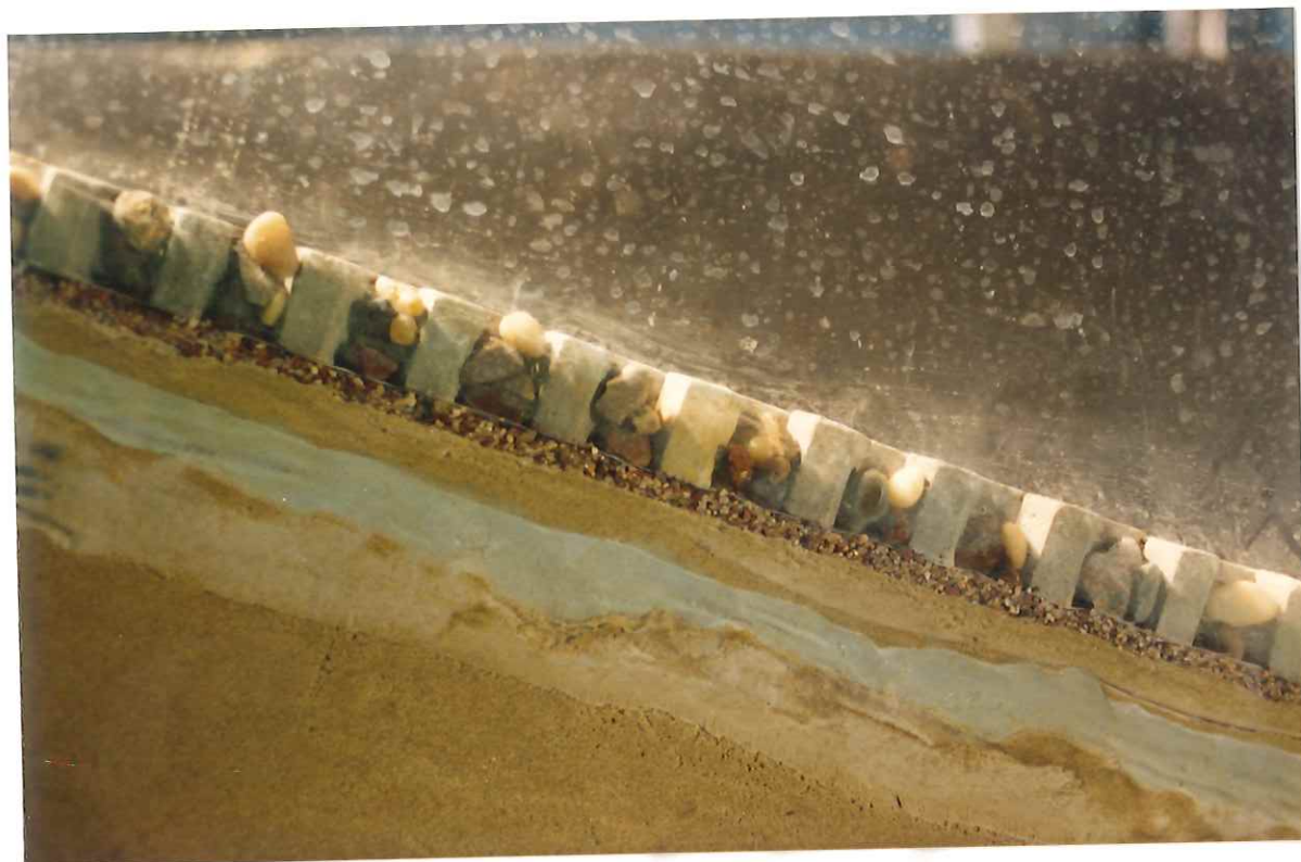
Foto 13: Protección de unidades Betoncover sobre filtro.
