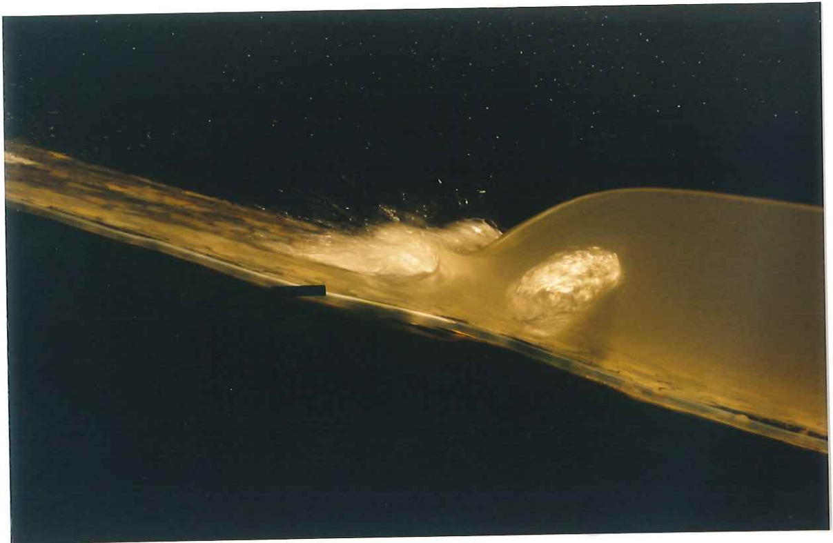
Foto 20: Ensayo 43 – unidades Betonplan – 1V:3H, Hs= 1.30, T= 4s.
