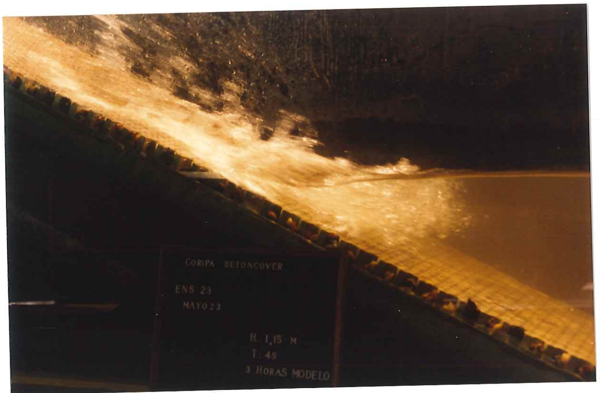
Foto 6: Ensayo 23 - unidades Betoncover - 1H:2V, H_s = 1.15 m, T = 4 s.
