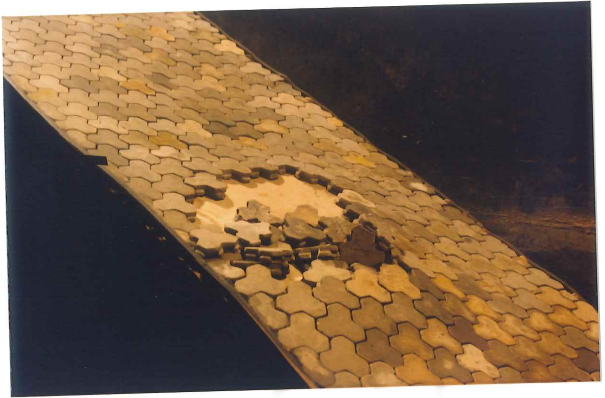
Foto 29: Estado final de la protección en el ensayo 46 – 1V:2H, T = 4 s
