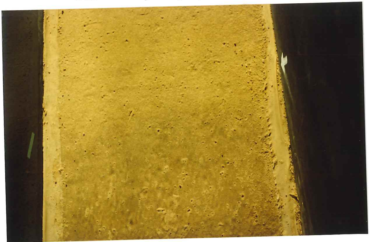
Foto 16: Estado final del terraplén de arena finalizado el ensayo 41A.
