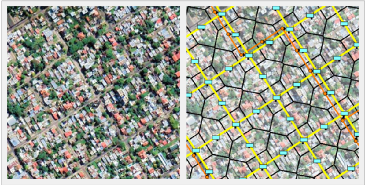
Figura 3.4: Imágen satelital (izq., Fuente: Google Earth) y esquema del modelo SWMM (der.). Límites entre subcuencas en negro, nodos de almacenamiento en celeste, calles en amarillo y conductos y nodos de unión en naranja.
