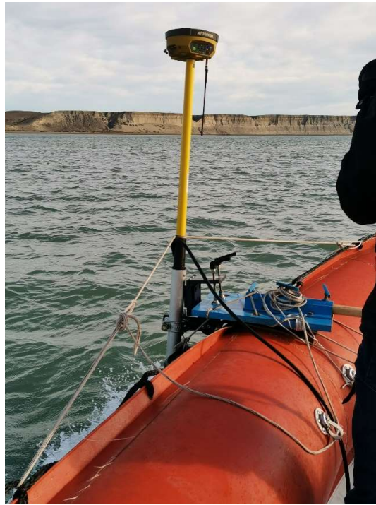
Figura A-I.13. Ecosonda en posición de medición y configuración utilizada.
