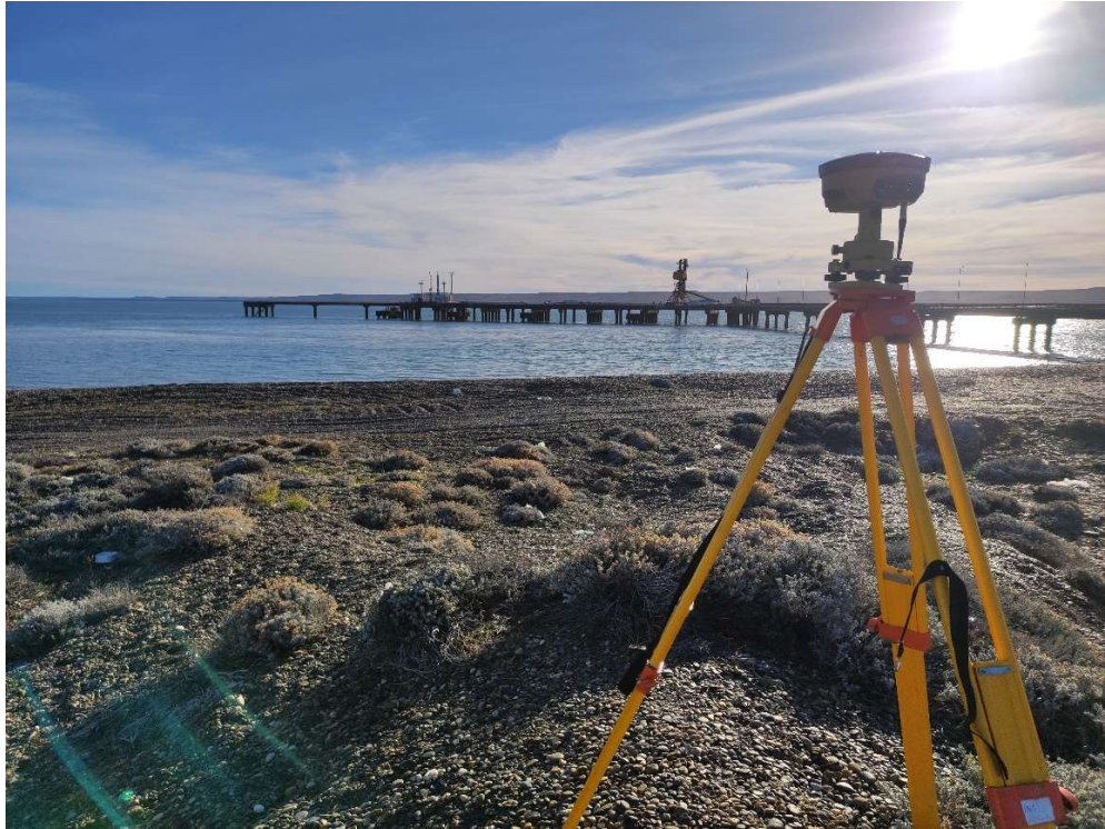
Figura A-I.6. Colocación de estación GPS para georreferenciación de datos.
