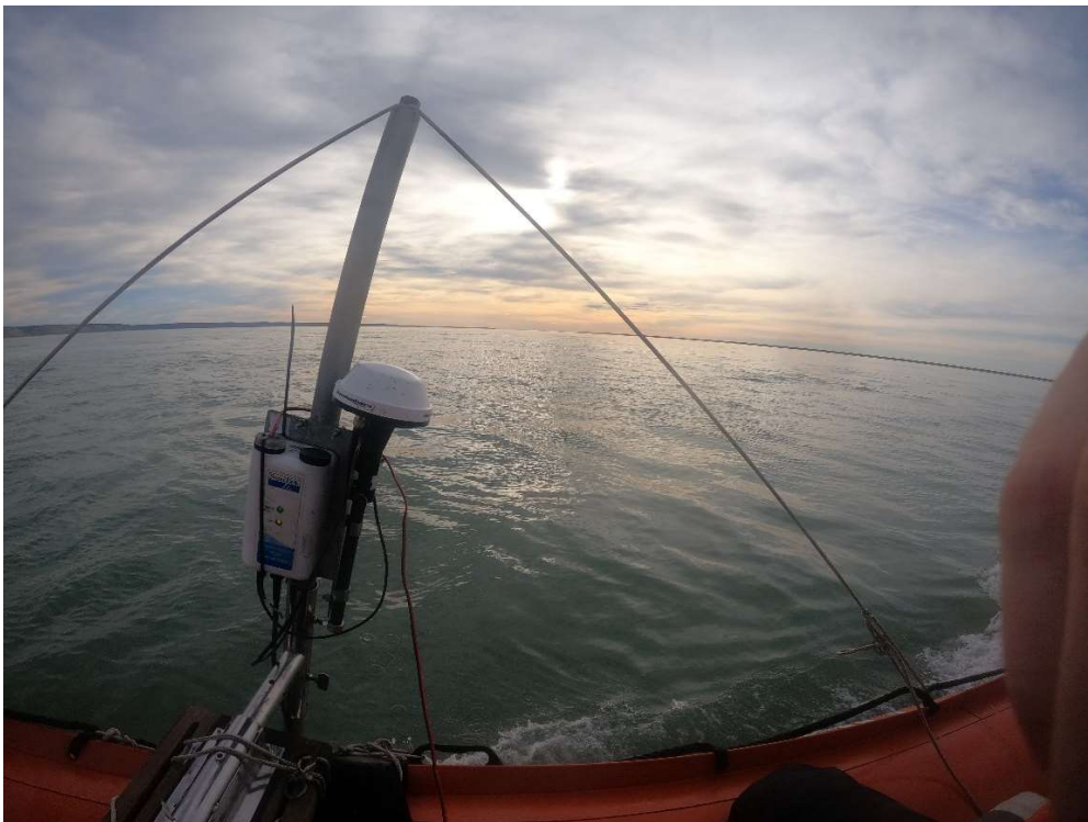
Figura A-I.12. ADCP en posición de medición y configuración utilizada.
