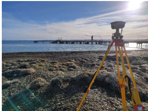
Figura 3.2. GPS Diferencial Topcon Hiper V.
