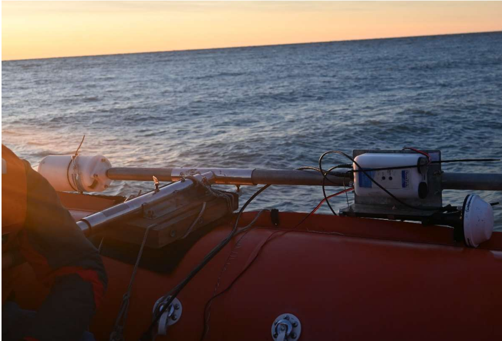
Figura A-I.11. ADCP en posición de reposo y configuración utilizada.
