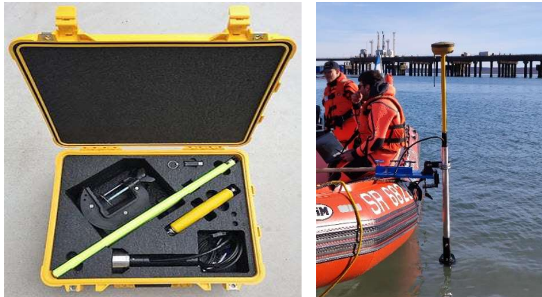
Figura 3.3. Ecosonda CEE LINE 200.
