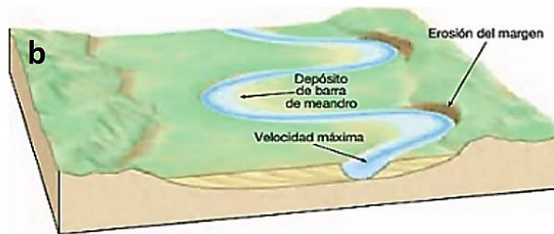
Figura 25. a) Viviendas ubicadas sobre el margen externo de la curva del río, Unquillo. b) Cauce meandriforme en el que se observa las zonas donde produce erosión y deposición de sedimentos.
