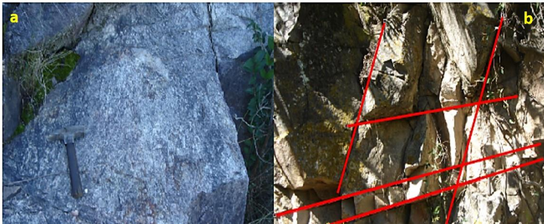
Figura 2. Imágenes del basamento metamórfico aflorante en inmediaciones al embalse La Quebrada. a) Aspecto del Gneis tonalítico dominante, con abundante Pl+Qtz+Bt. Se observa un bandeo cíclico melano y leucocrático (largo de la piqueta: 30 cm). b) El Gneis se muestra bastante fracturado, favorecido por la fábrica de la roca.
