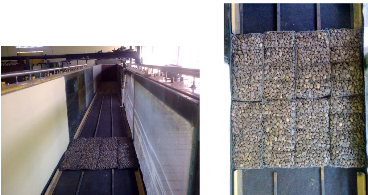
Figura 5.- Colchonetas de sostenimiento de la manta en el tramo central del canal
