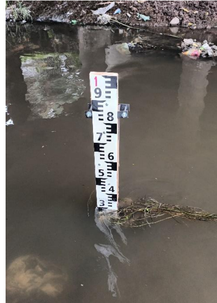
Figura A.14. Nivel del curso registrado por la regla hidrométrica de la EM08
