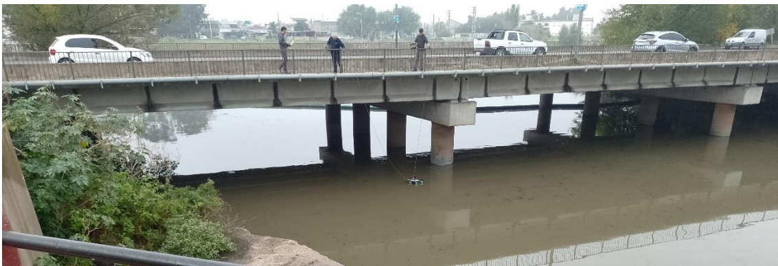
Figura A.56. Aforo con el ADCP mediante sogas desde el puente de la Av. 27 de Febrero en la EM17
