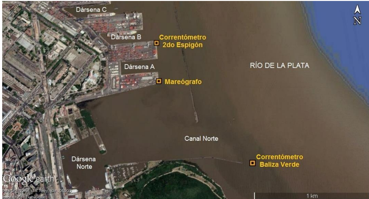
Figura 6-1. Ubicación de correntómetros y mareógrafo en el Puerto de Buenos Aires
