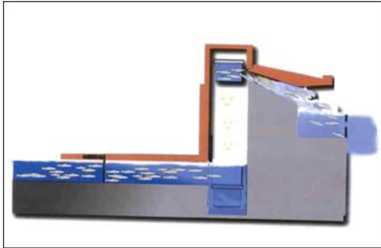
Figura 1.2.6 Estructura de transferencia de peces
