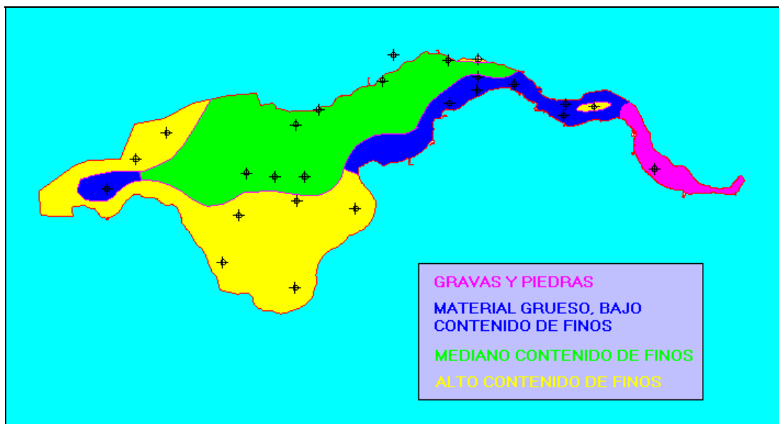
Figura 3.3.13 Distribución granulométrica de sedimentos en planta según mediciones
