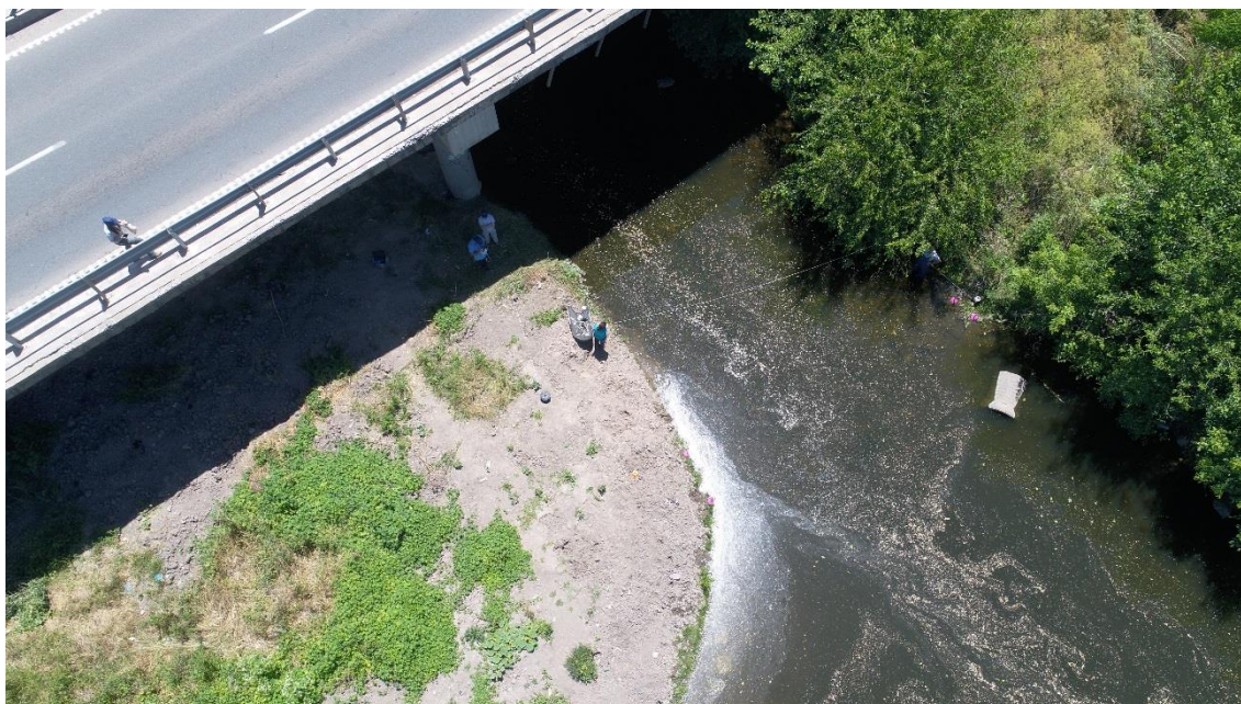
Figura A.5. Vista aérea de los puntos fijos (conos violetas) y de los trazadores (viruta de madera) para la aplicación de la técnica LSPIV en la EM01.
