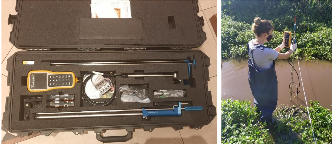
Figura 2.2. ADV FlowTracker2 Sontek con sus diversos componentes (izquierda) y utilización del equipo en los aforos del presente proyecto (derecha).
