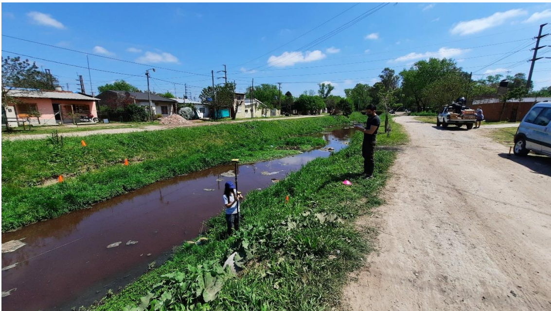
Figura A.33. Disposición y relevamiento de coordenadas de los puntos fijos para implementar la técnica LSPIV.
