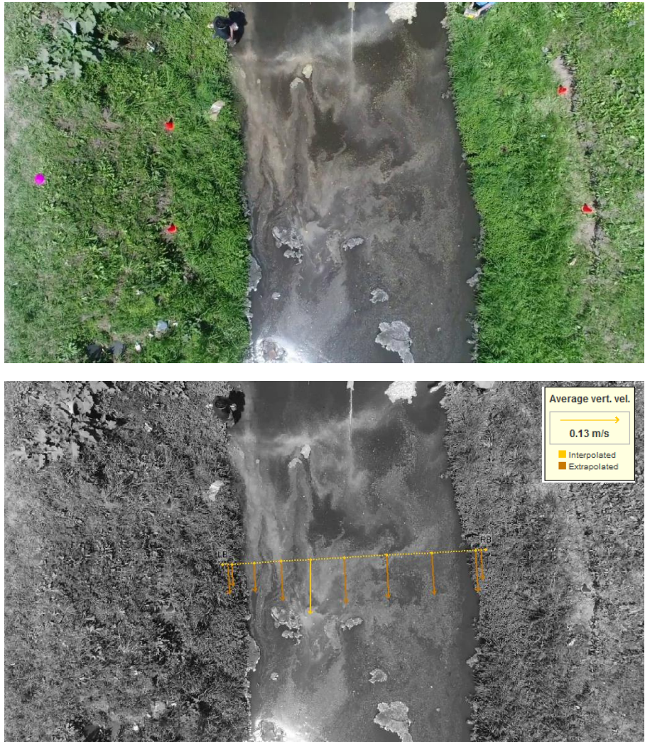
Figura A.34. Campo de velocidades superficiales en la EM63 obtenido con el software Fudaa.
