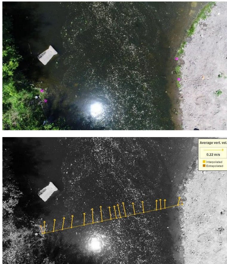
Figura A.6. Campo de velocidades superficiales obtenido con el software Fudaa.
