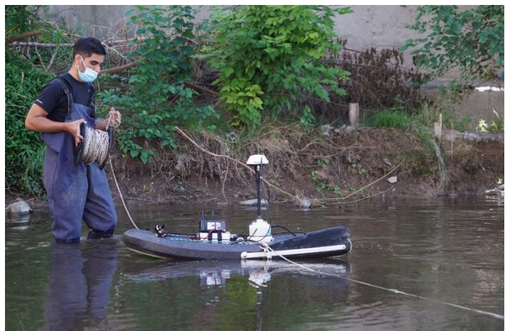
Figura 2.4. Configuración de los sensores del ADCP RiverSurveyor M9 (izquierda) y utilización del equipo en los aforos del presente proyecto (derecha)
