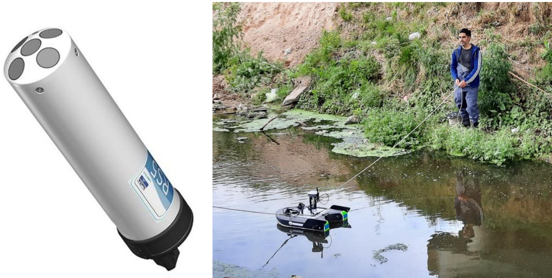
Figura 1.4. Configuración de los sensores del ADCP RS5 (izquierda) y utilización del equipo en los aforos del presente proyecto (derecha)
