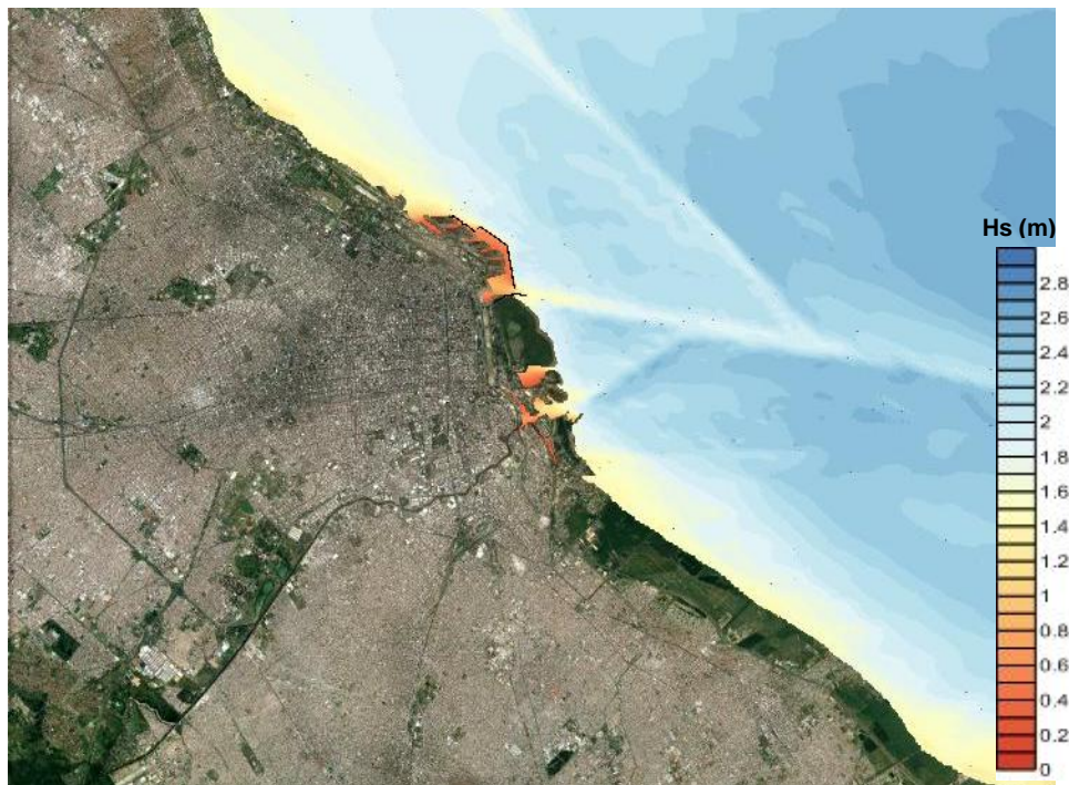
Figura 2.2. Campo de alturas de olas en cercanías del puerto. Escenario Viento SE Tr=20 años.
