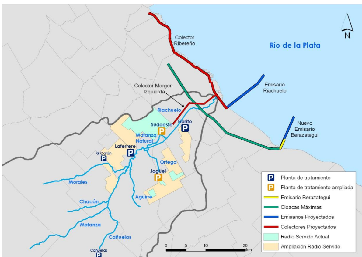
Figura 5.3.1. Obras involucradas en el PDA
