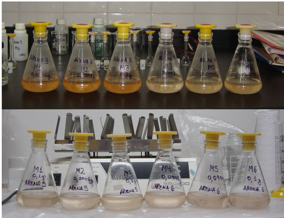
Figura 2: Comparación de la coloración del agua finalizado el ensayo de máxima capacidad de adsorción - Arenas 3, 4, 5 y 6.
