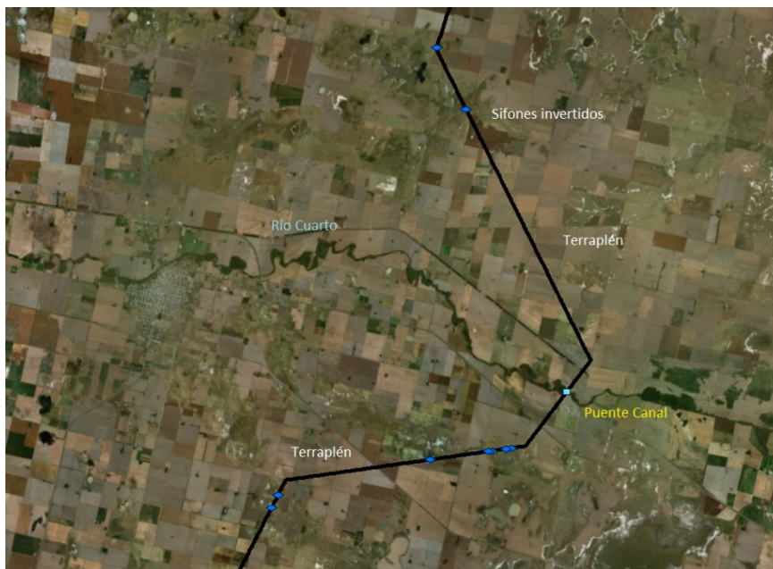
Figura 2.13 Traza del puente canal sobre el río Cuarto.
