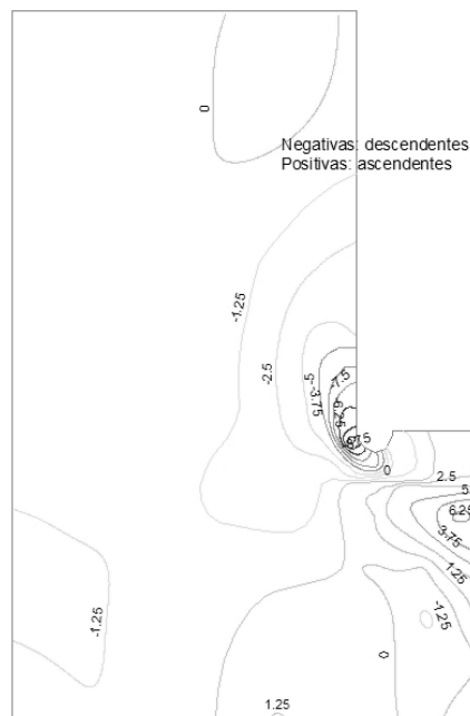
Figura 8.- Velocidades verticales ( V_z ) en el modelo físico. Q=385 lt/s, h=25 cm, contracción 5,25 m.
