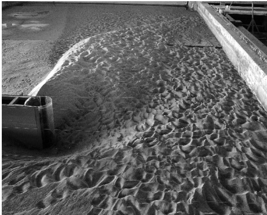
Figura 4.- Configuración final del fondo móvil. Ensayo: Q=385 lt/s, h=25 cm, contracción 5,25 m.
