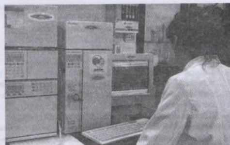
Figura 13. Cromatógrafo de alta eficiencia (HPLC). Laboratorio LETS-CTUA del INA
