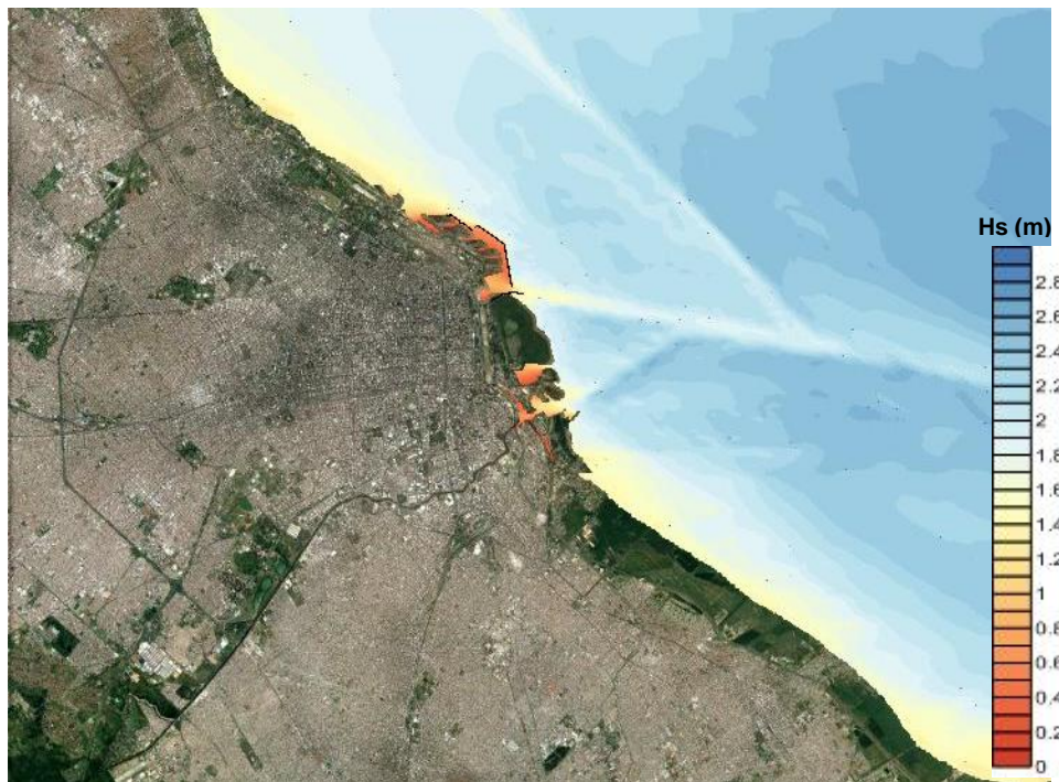
Figura 4.6. Campo de alturas de olas en cercanías del puerto. Escenario Viento SE Tr=20 años.
